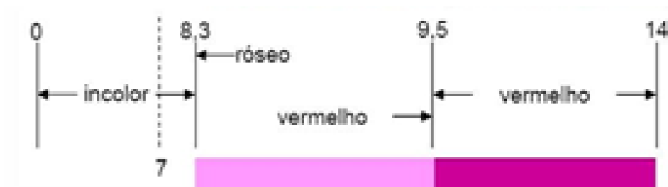
Figura 26- Classificação do Ph através da coloração do substrato quando submergido a solução de fenolftaleína
