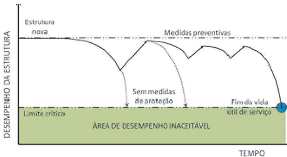
Figura 3- Variação do desempenho de estruturas de concreto
