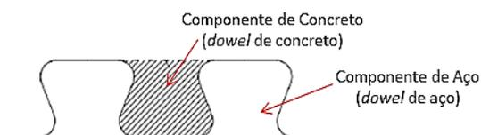
Figura 2.11 – Representação esquemática dos componentes na conexão com conectores em chapa.
