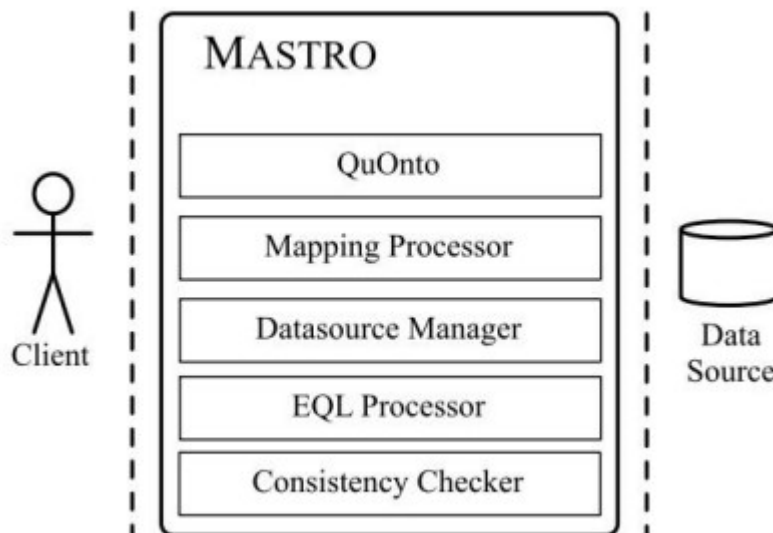
Figura 59 - Arquitetura básica do MASTRO
