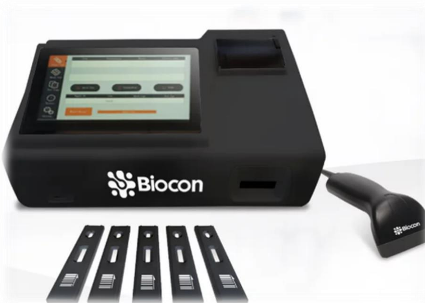
Figura 11 - AFR200, dispositivos testes e leitor de códigos de barras. Foto do equipamento AFR-200 de imunofluorescência e seus componentes: dispositivos testes e leitor de códigos de barras. Fonte: Arquivo Biocon
