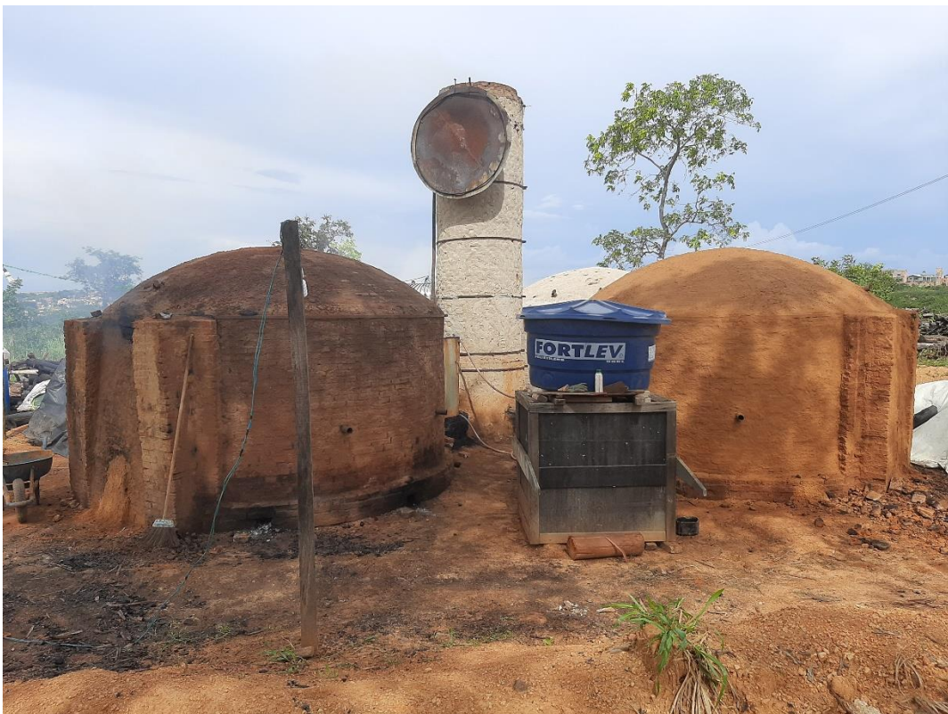
Figura 1. Sistema fornos-fornalha para produção de carvão vegetal Fonte: Os autores.
