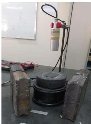
Figura 4.24 – Ensaio de atenuação da radiação em placas Fonte: Elaborado pelo autor
