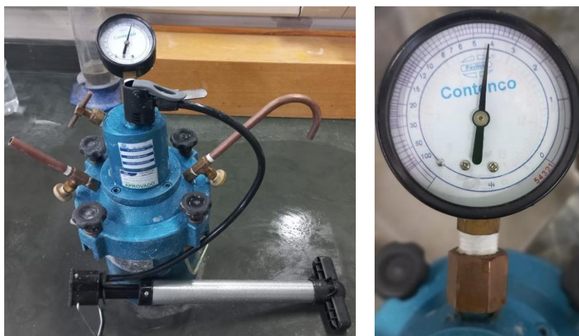
Figura 4.8 - Medidor do teor de ar incorporado à argamassa Fonte: Elaborado pelo autor
