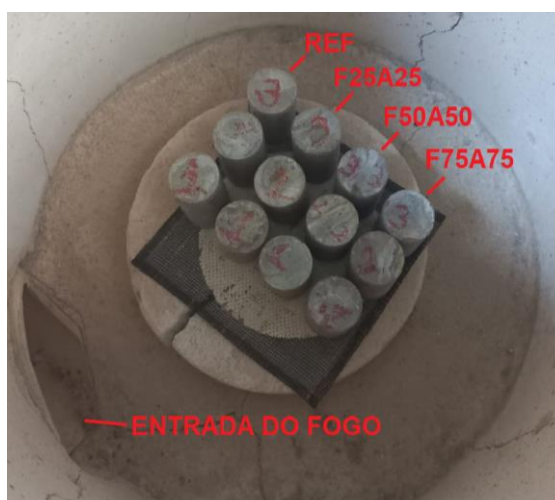
Figura 5.34 - Posicionamento das amostras no interior do forno Fonte: Elaborado pelo autor
