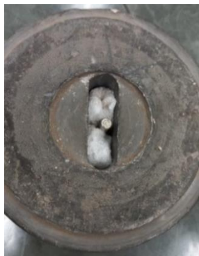
Figura 4.23 – Fonte radioativa envolvida pela espuma Fonte: Elaborado pelo autor
