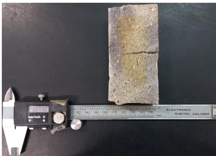
Figura 4.19 - Ensaio profundidade penetração de cloretos Fonte: Elaborado pelo autor
