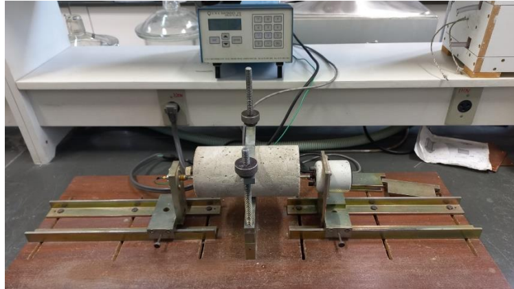
Figura 4.11 - Montagem do equipamento para ensaio de módulo de elasticidade dinâmico Fonte: Elaborado pelo autor
