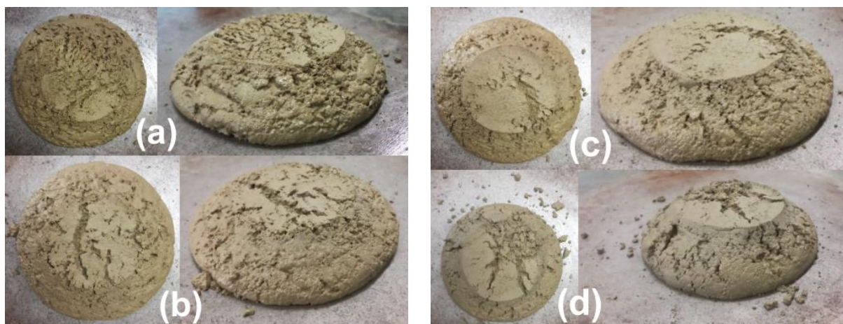
Figura 5.6 – Espalhamento no teste de Flow Table da argamassa (a) REF , (b) F25A25 , (c) F50A50 e (d) F75A75
