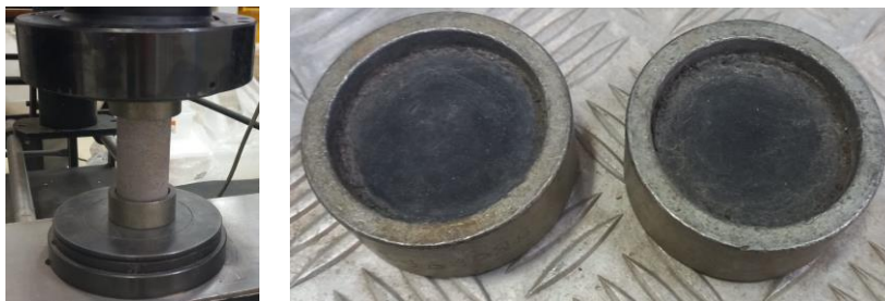
Figura 4.21 – Ensaio de resistência à compressão residual Fonte: Elaborado pelo autor
