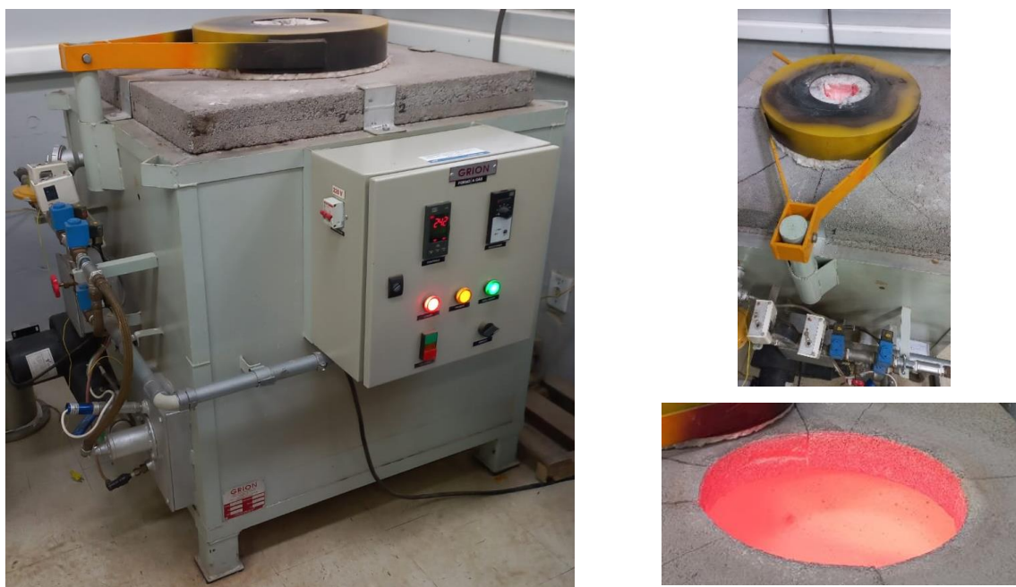
Figura 4.20 - Forno para ensaio simulador de incêndio Fonte: Elaborada pelo autor
