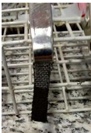
Figura 6: Eletrodo produzido a partir dos pós sintetizados, negro de fumo e PVDF, suportado pelo tecido de carbono.
