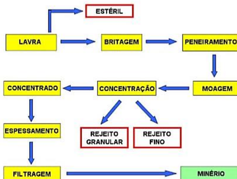
Figura 3 - Esquema típico de processamento do minério de ferro
