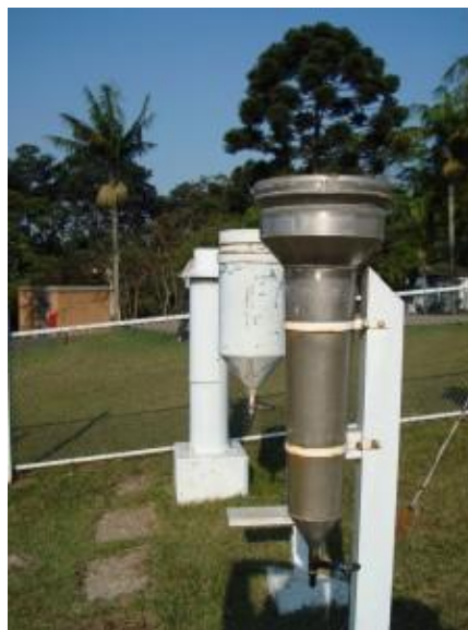
Figura 3.2: Pluviômetro Ville de Paris em inox.
