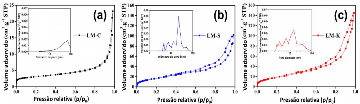
**Figura 5.3:** Isotermas de sorção de N<sub>2</sub> e distribuições de tamanhos de poros de (a) LM-C, (b) LM-S e (c) LM-K.
