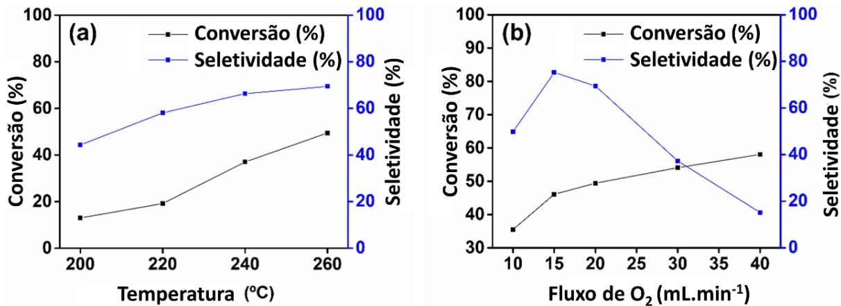
**Figura 5.7:** Comportamento catalítico do LM-C em função (a) da temperatura de reação e (b) do fluxo de O<sub>2</sub>.
