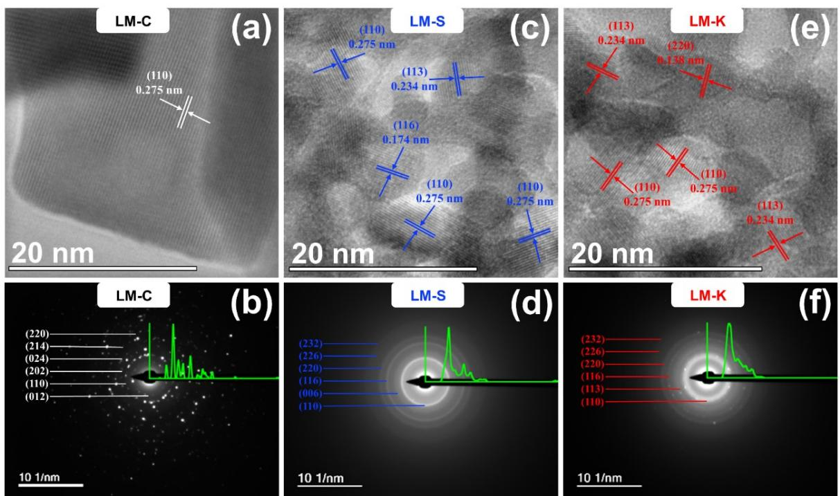
**Figura 5.5:** Imagens MET de alta resolução de (a) LM-C, (c) LM-S e (e) LM-K. Padrões SAED de perovskitas (b) LM-C, (d) LM-S e (f) LM-K.
