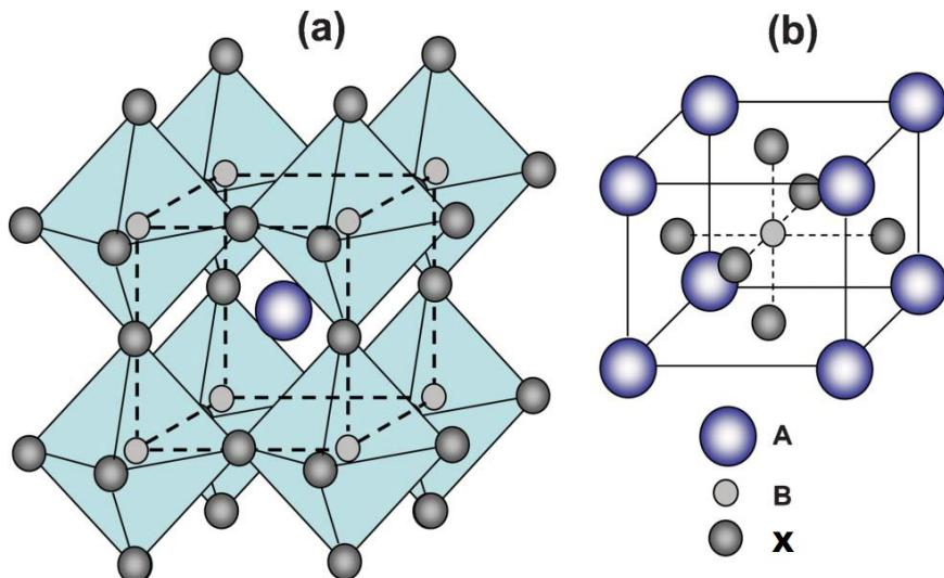
**Figura 3.2:** Estrutura de perovskita  $\text{ABX}_3$ : (a) octaedro de compartilhamento de borda ( $\text{BX}_6$ ) com íon no sítio A coordenado por 12 íons do sítio X; (b) cátion no sítio B no centro da célula.
