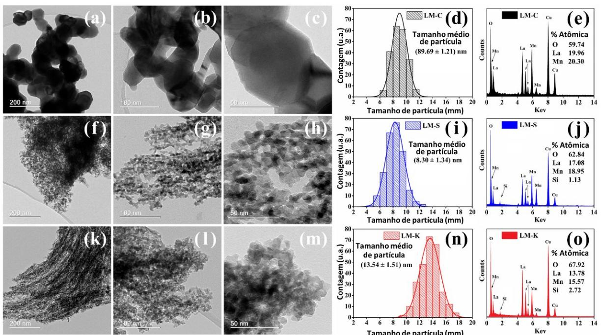
**Figura 5.4:** Micrografias MET de (a-c) LM-C, (f-h) LM-S e (k-m) LM-K. Distribuições de tamanho de partícula de (d) LM-C, (i) LM-S e (n) LM-K. Espectros EDS de (e) LM-C, (j) LM-S e (o) LM-K.
