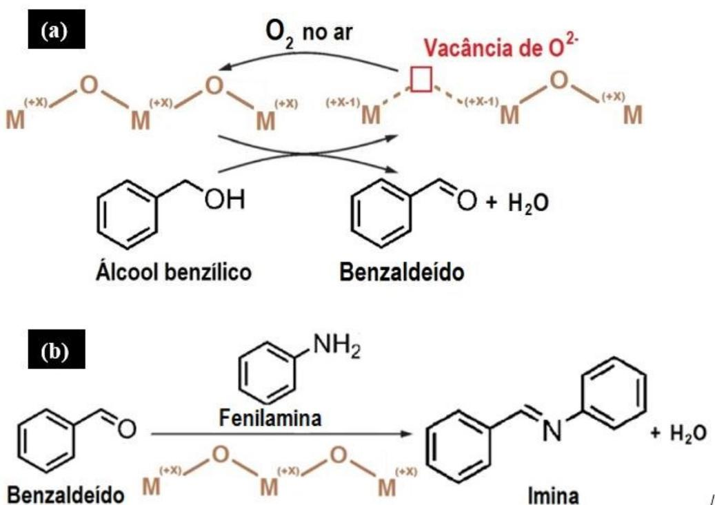
**Figura 3.7:** Mecanismo de reação para a formação de iminas por meio do acoplamento oxidativo de álcoois e aminas: (a) Reação de formação do benzaldeído e (b) reação de condensação.
