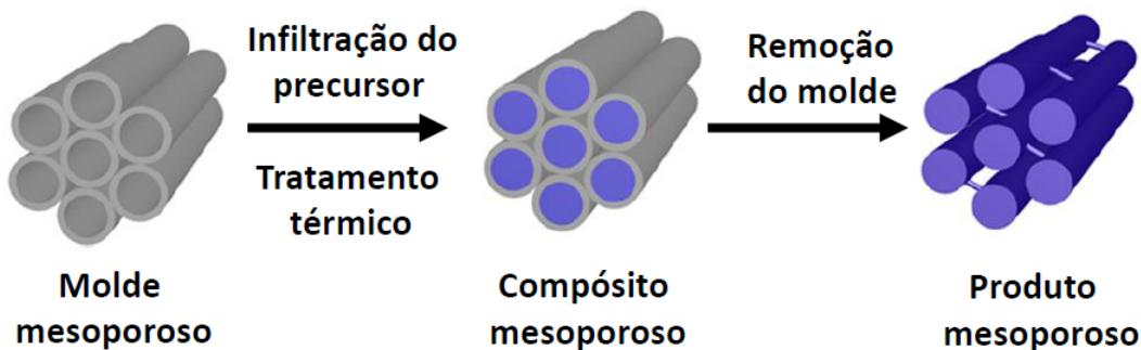
**Figura 3.4:** Representação esquemática das etapas envolvidas na síntese de material com estrutura de poros ordenada mediante uso de sílica SBA-15 como molde rígido.
