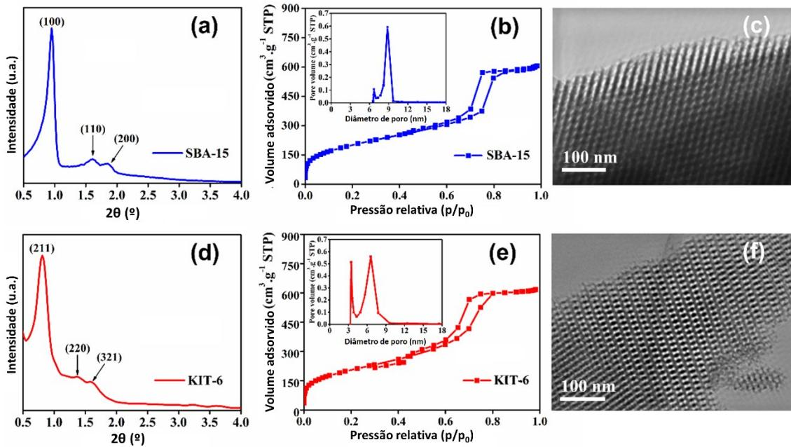
**Figura 5.1:** Padrão de DRX de baixo ângulo para (a) SBA-15 e (d) KIT-6. Isotermas de sorção de N<sub>2</sub> e distribuição de tamanhos de poros de (b) SBA-15 e (e) KIT-6. Micrografias obtidas por MET para (c) SBA-15 e (f) KIT-6.
