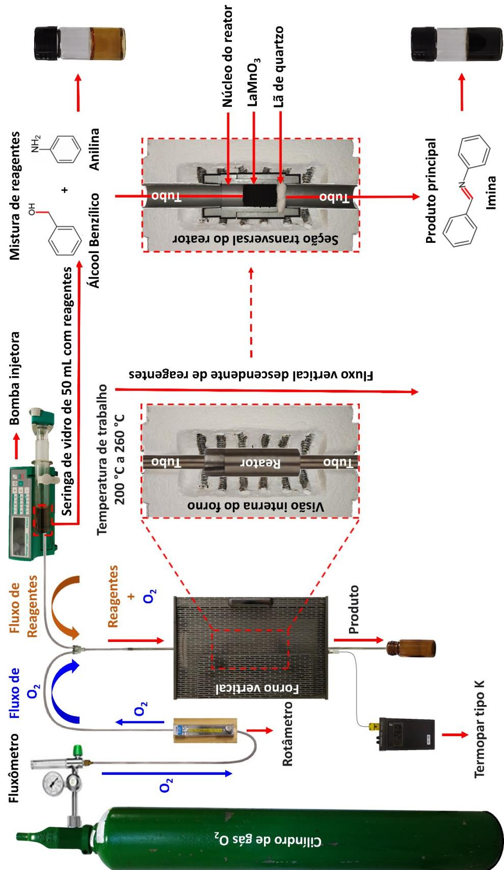
Figura 4.4: Montagem real dos instrumentos e equipamentos utilizados na síntese de imina.
