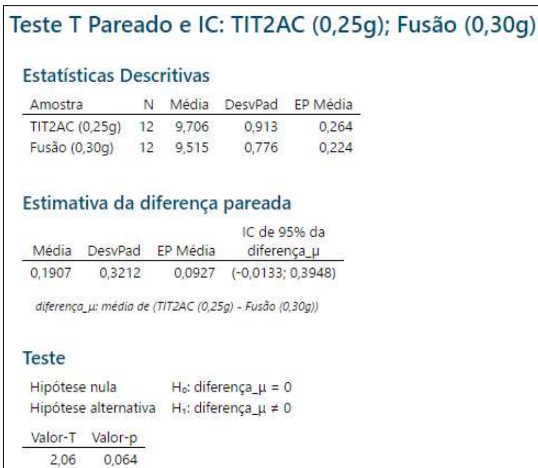
Figura 5.81 – Resultados do teste-T pareado no comparativo ( p\text{-valor} > 0,05 ) entre o método de digestão ácida (2-ácidos) e o método de pastilha fundida / FRX para as amostras do Grupo B.
