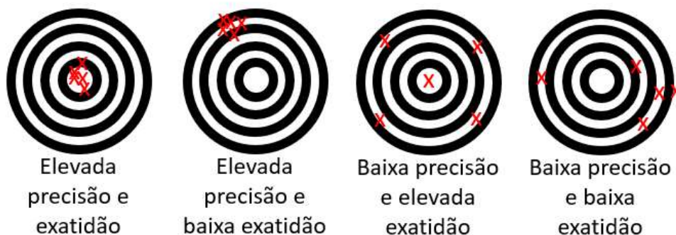
Figura 3.6 – Comportamentos que um método analítico pode ter em relação a exatidão e precisão. Fonte: o autor.
