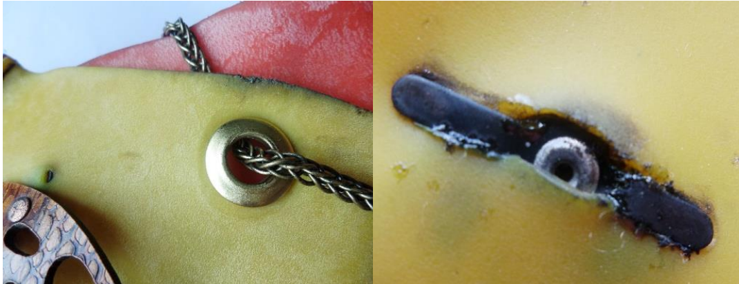
Figura 3 - Rompimento e oxidação dos objetos metálicos em protótipo de FSA
