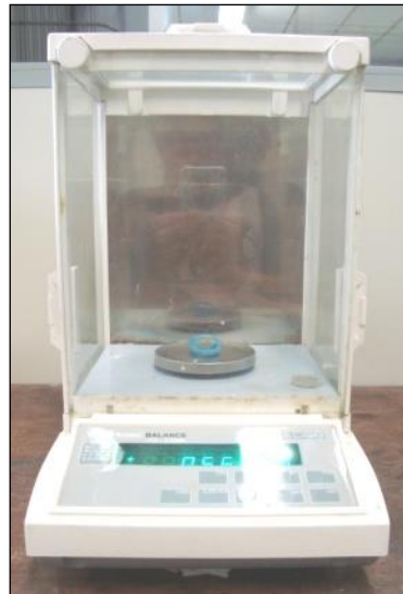
Figura 8 – Sistema balança analítica de precisão com amostra injetada em cera
