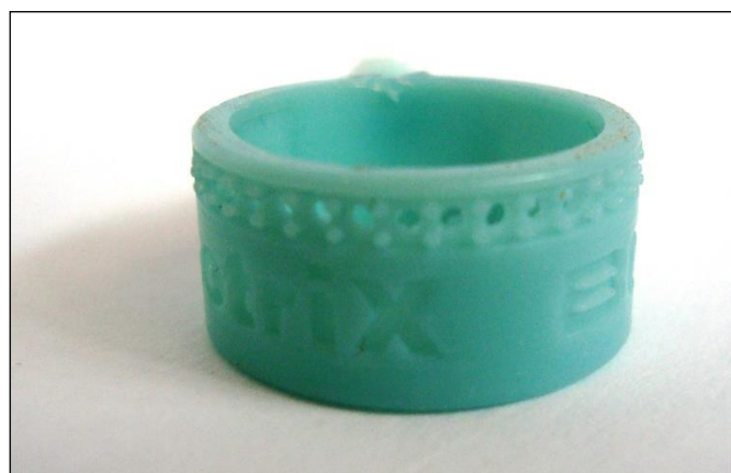
Figura 2 – Anel injetado em borracha para cravação de gemas
