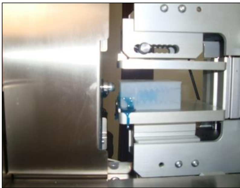
Figura 6 – Aumento da pressão de injeção de cera leva a excesso de material injetado
