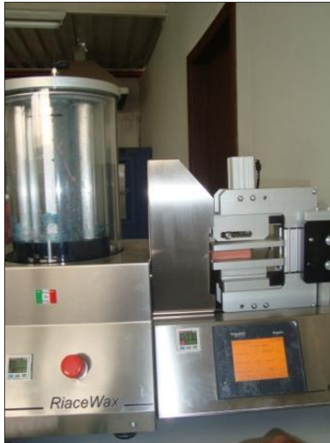
Figura 3 – Injetora de cera RiaceWax, com uma estação de trabalho e molde de borracha
