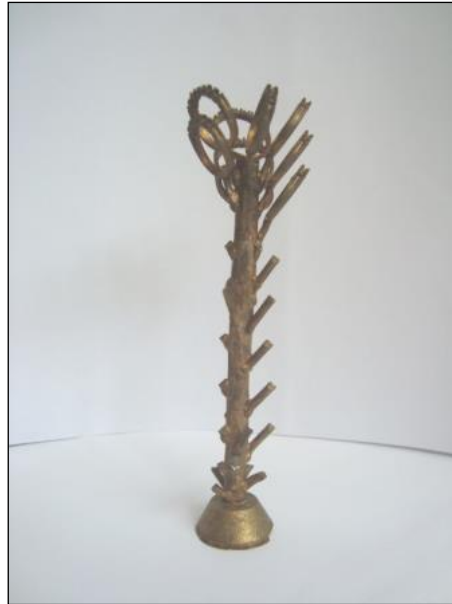
Figura 4 – “Árvore” de metal com alguns anéis fundidos
