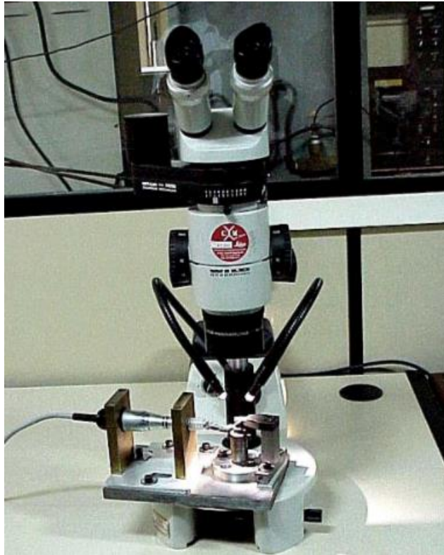
FIGURA 1: Bancada de teste posicionada sob a lupa estereoscópica
