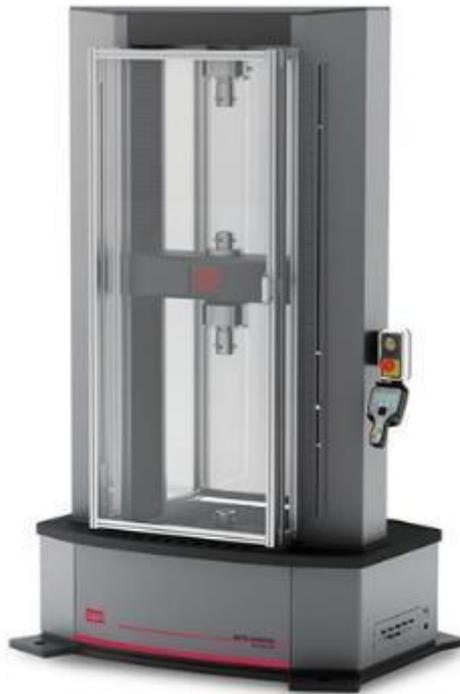
Figura 4.1: Máquina utilizada para realização dos ensaios de tração.
