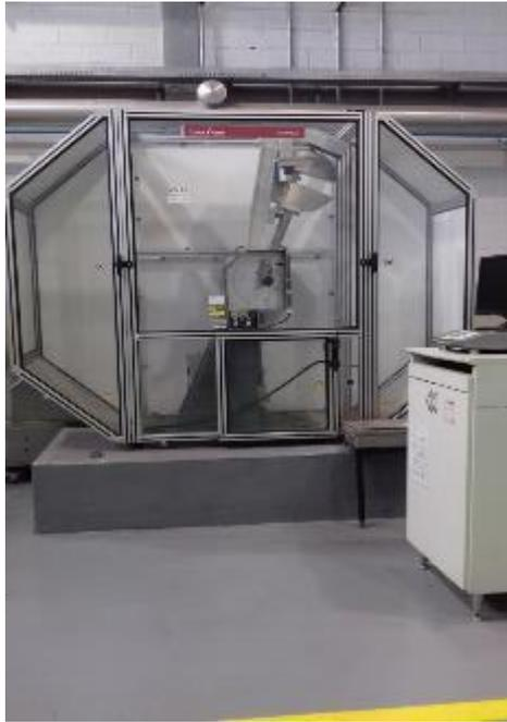
Figura 4.4: Máquina utilizada para os ensaios de impacto Charpy.
