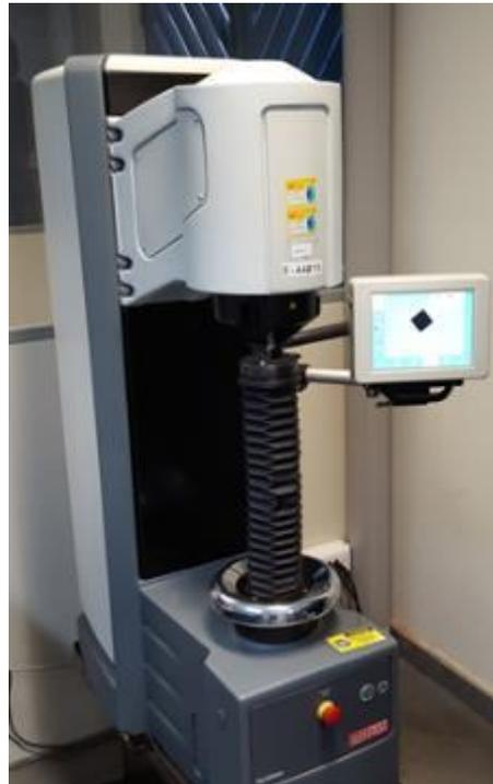
Figura 4.3: Microdurômetro utilizado para os ensaios de dureza Vickers.
