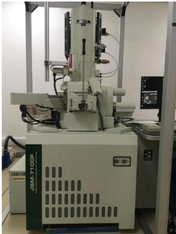
Figura 4.7: Microscópio eletrônico de varredura utilizado nas análises microestruturais.
