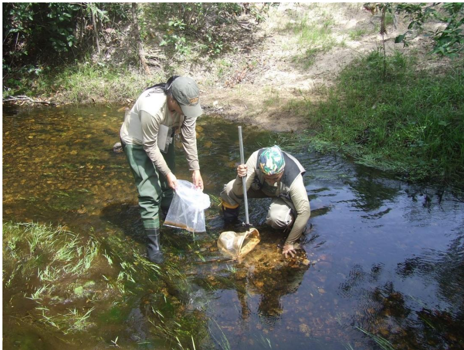
Figura 6 – Coleta de macroinvertebrados utilizando um coletor do tipo “kick-net”, ou Rede D, em 11 transectos do trecho amostral, seguindo o padrão tipo zigue zague: margem esquerda – centro - margem direita.
