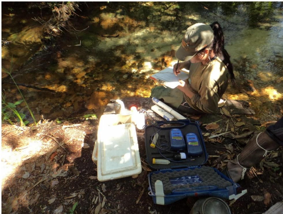
Figura 5 – Mensuração de parâmetros físicos e coleta de água para avaliação dos parâmetros químicos de qualidade da água.
