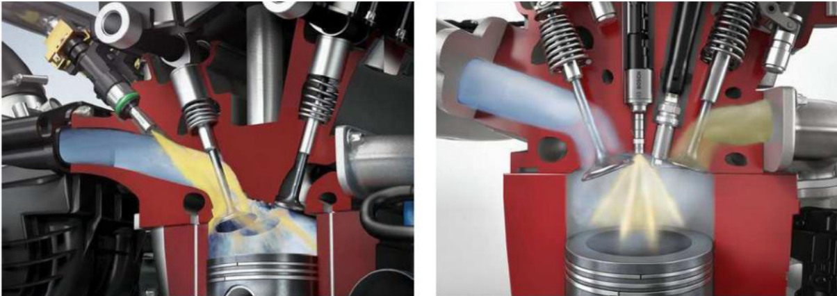
Figura 5 – Sistemas de injeção de combustível: (Esquerda) PFI (Direita) DI
