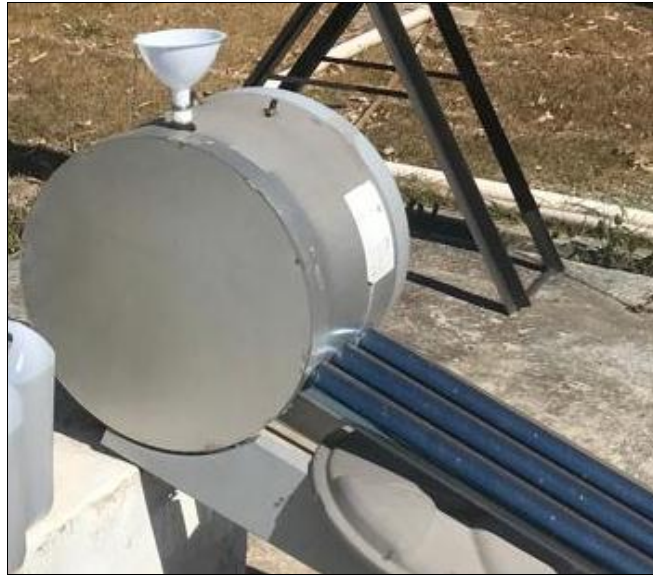
Figura 4.6 – Detalhe do mecanismo de alimentação do sistema
