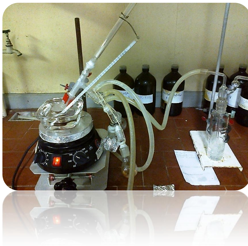
Figura 20 - Representação do processo de purificação da anilina por destilação simples.
