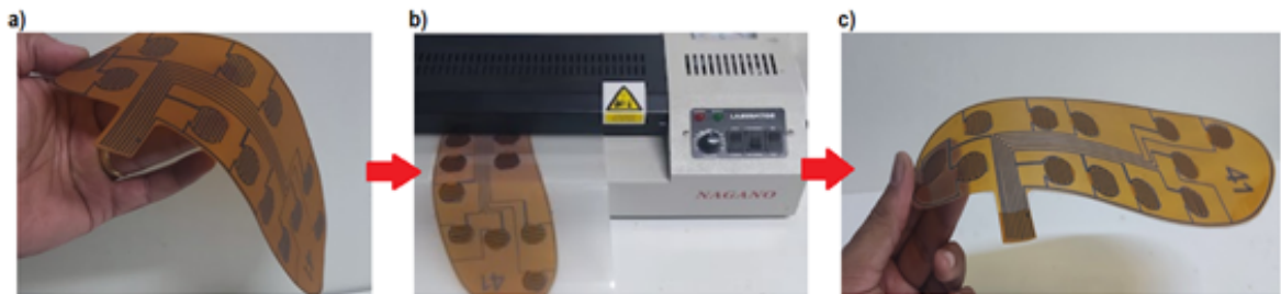
Figura 3.22: Ganho de rigidez da PS após a laminação com Poliseal: a) Circuito após o processo de corrosão, b) Laminação a quente com Poliseal e c) Circuito laminado com ganho de rigidez.
