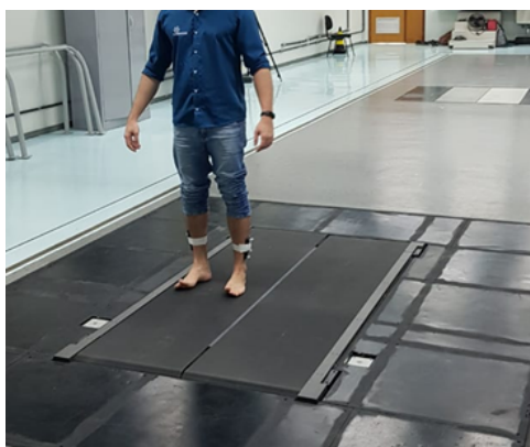
Figura 2.11: Plataforma de força UFMG-LAM associada a esteiras para captação das Forças de Reação do Solo (FRS) durante a marcha.
