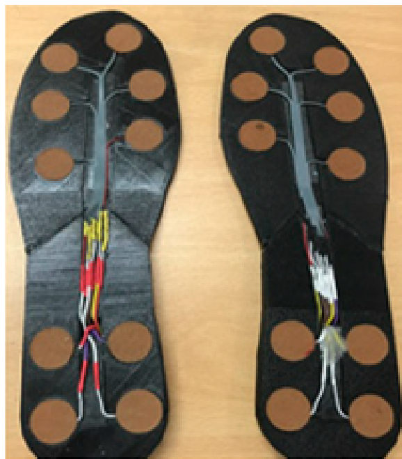
Figura 3.3: Palmilha Sensorizada utilizando sensores comerciais com conexões soldadas.
