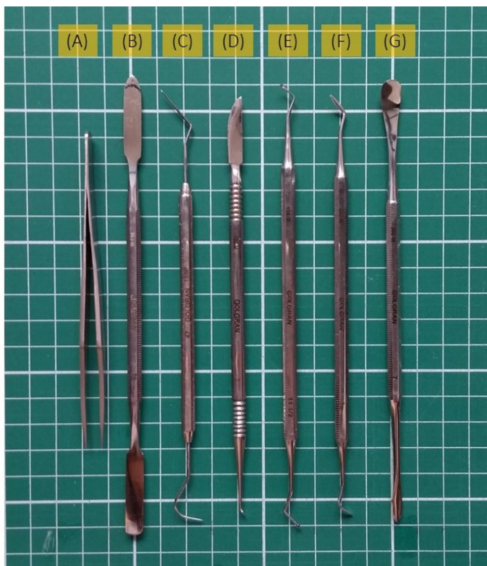
Figura 68 – Ferramentas complementares utilizadas para remoção das camadas pictóricas de revestimento
