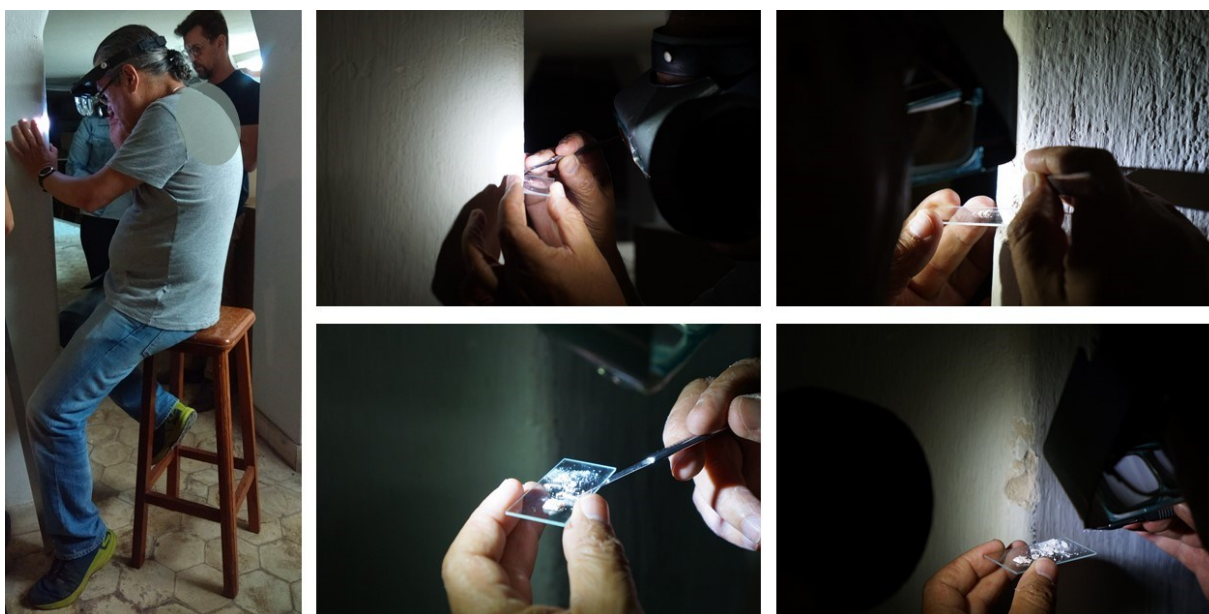
Figura 54 - Processo de retirada de amostras de tinta em uma parede
