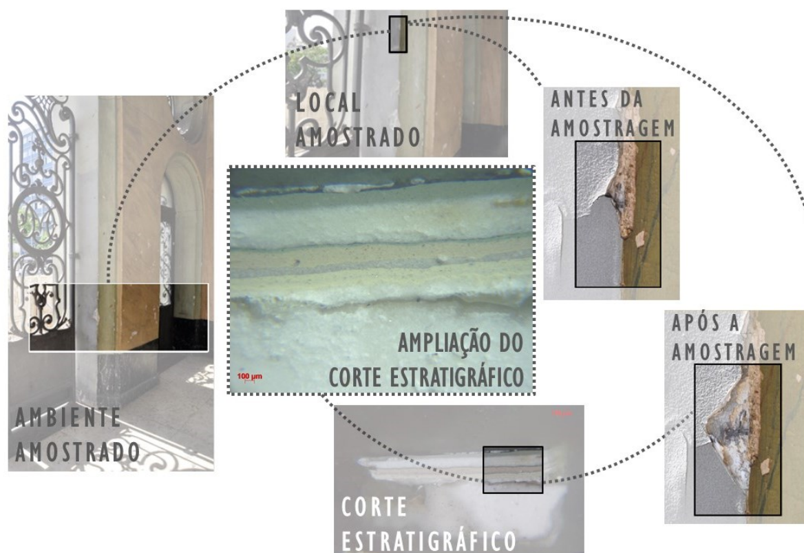
Figura 3 – Infográfico da elaboração do corte estratigráfico
