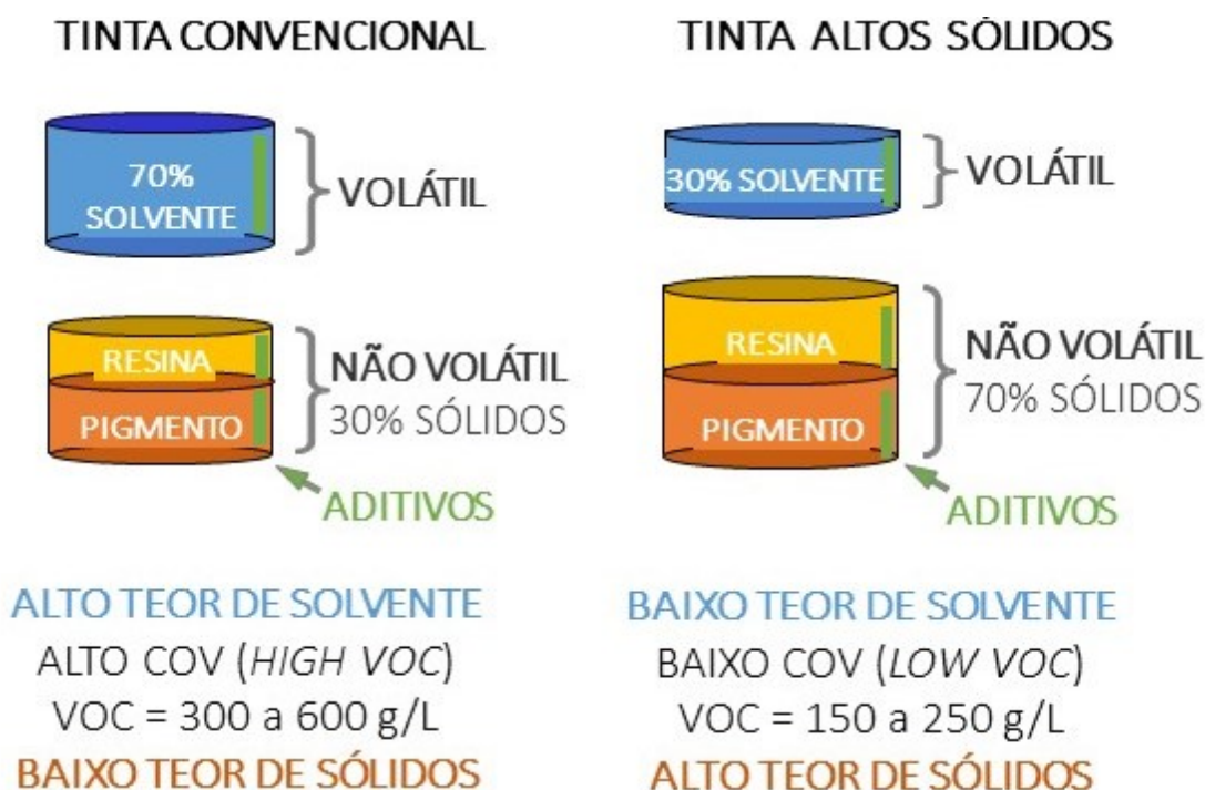
Figura 16 - Tipos de tinta quanto aos solventes
