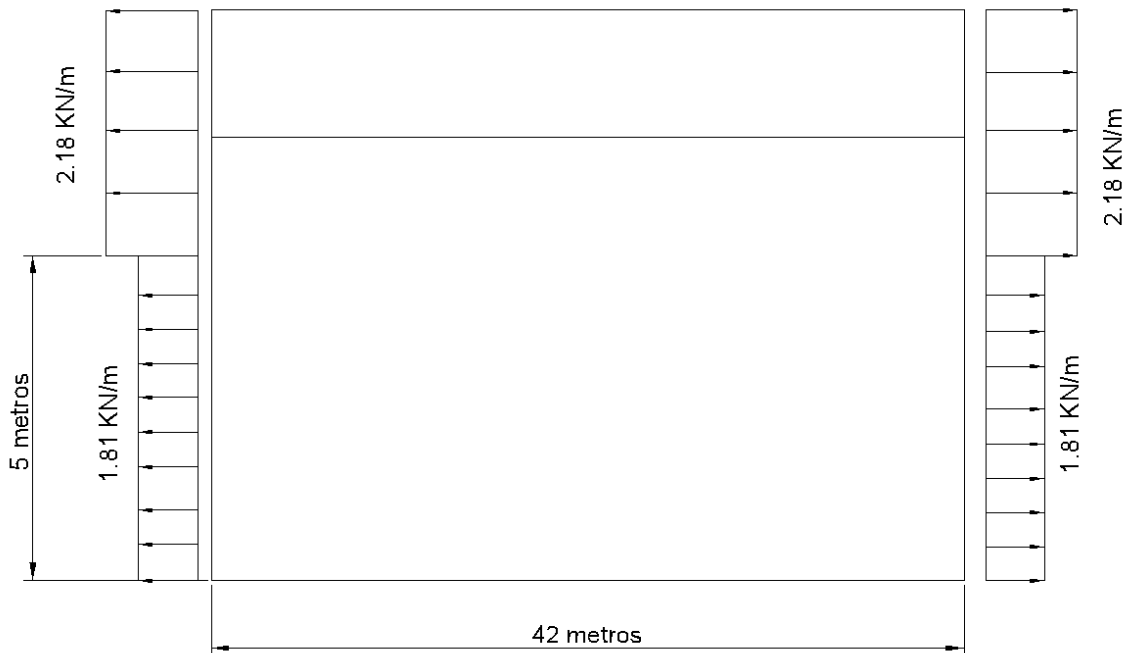
Figura 28: Forças finais nos pórticos externos devido vento ao transversal – Pilar da 2ª água.
