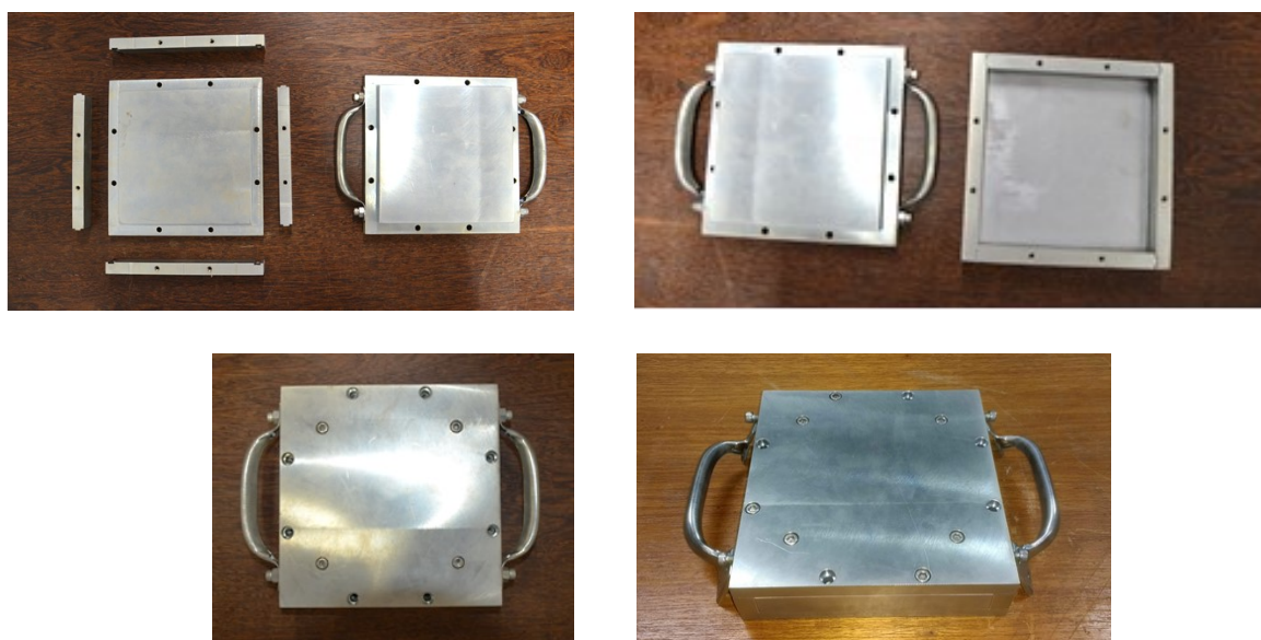
FIGURA 38 – Molde metálico para preparação das placas de compósitos híbridos para retirada dos corpos de prova pelo processo de termo moldagem.
