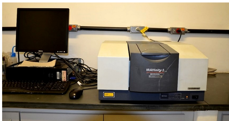
FIGURA 33 – Equipamento espectrofotômetro de infravermelho IRAffinity-1, marca SHIMADZU.
