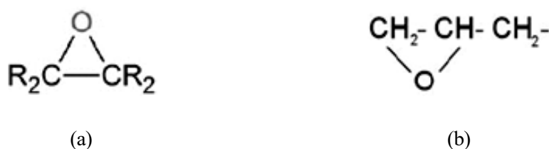
FIGURA 15 -- Estrutura de grupos epóxi funcionais: a) oxirano; b) glicidil FONTE -- BROSTOW, GOODMAN e WAHRMUND, 2014
