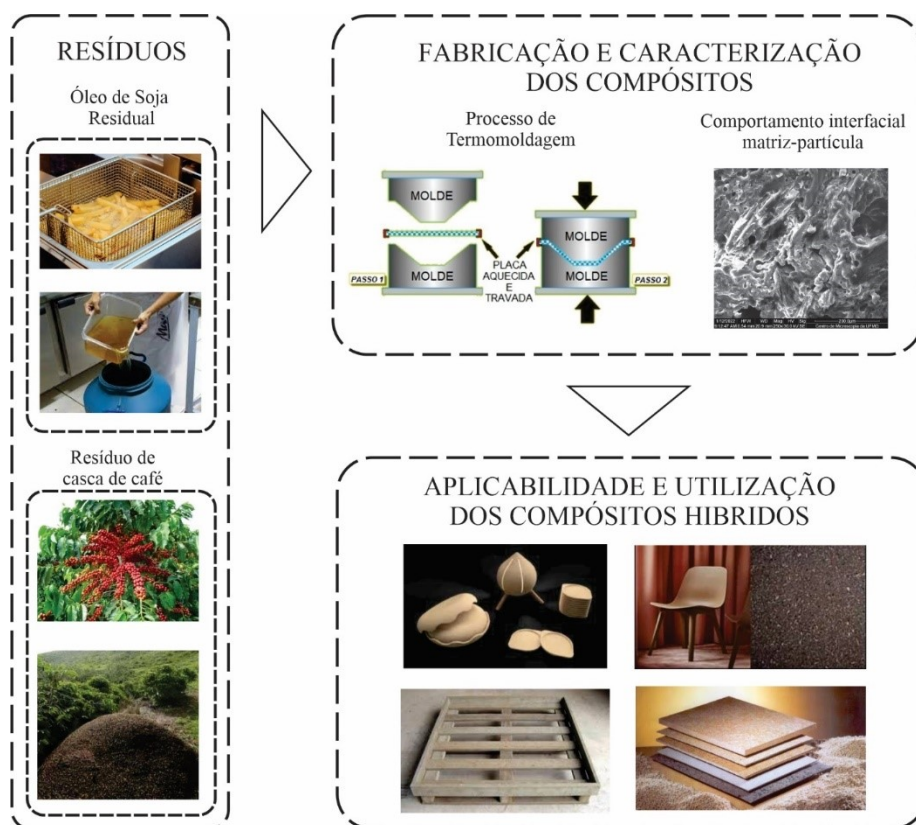
FIGURA 34 - Compósitos híbridos constituídos de resíduos lignocelulósicos (casca de café) e misturas de resinas epóxi sintética e de óleo vegetal epoxidado: a) aproveitamento de resíduos para a produção de materiais compósitos, b) processo de fabricação por moldagem a quente e análise de adesão interfacial e (c) aplicações estruturais do novo compósito.
