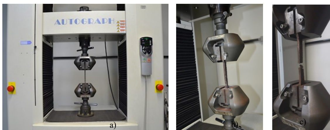
FIGURA 41 – Montagem do ensaio de tração. (a) amostra posicionada na máquina de ensaio AUTOGRAPH; (b) momento antes do ensaio; e (c) após o ensaio.
