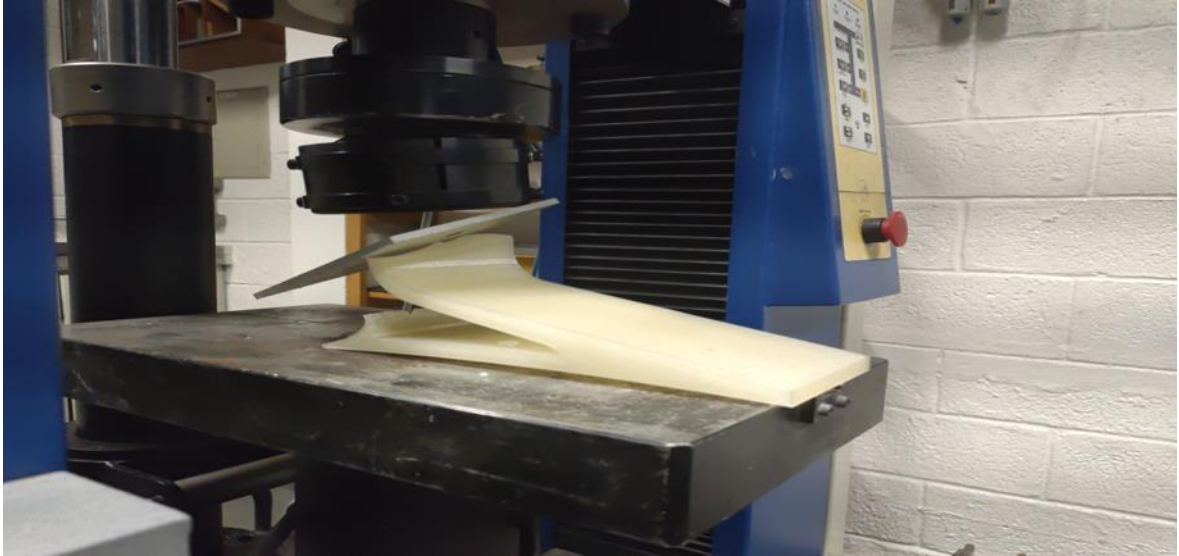
Figura 45 – Prótese em PLA rompida.
