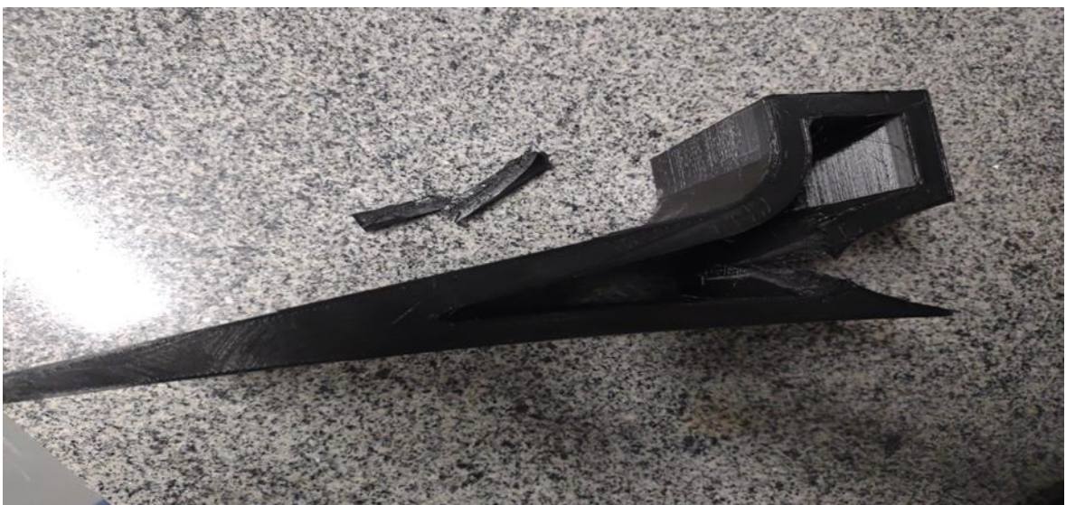
Figura 50 – Prótese em PETG rompida.
