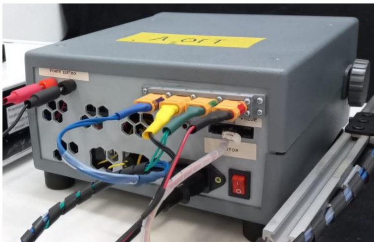
Figura 16. Versão final do gabinete eletro-eletrônico (visão traseira).
