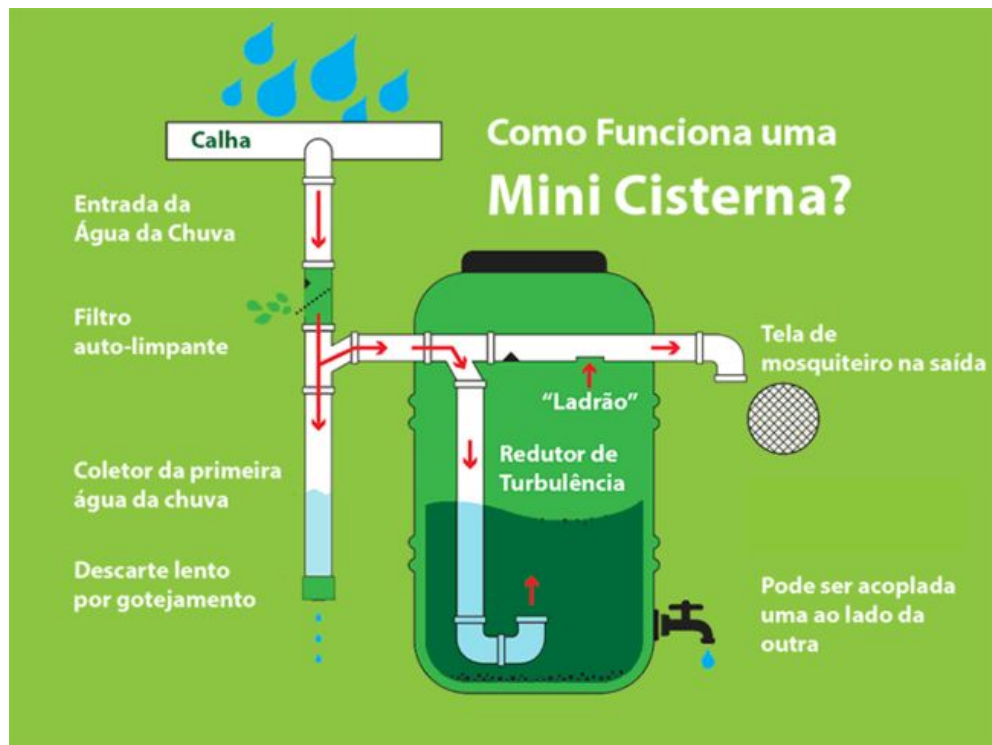
FIGURA 10: Esquema de funcionamento de uma cisterna.
