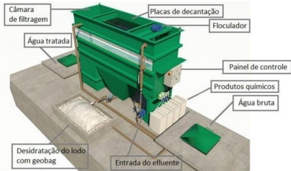
FIGURA 13: Estação de tratamento de água de reuso
