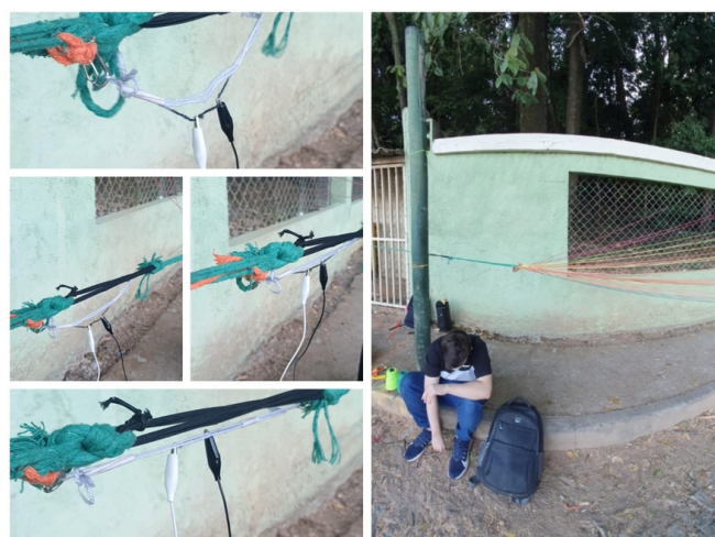
Figura 40 – Amarração do sensor de tensão na intervenção de AIA
