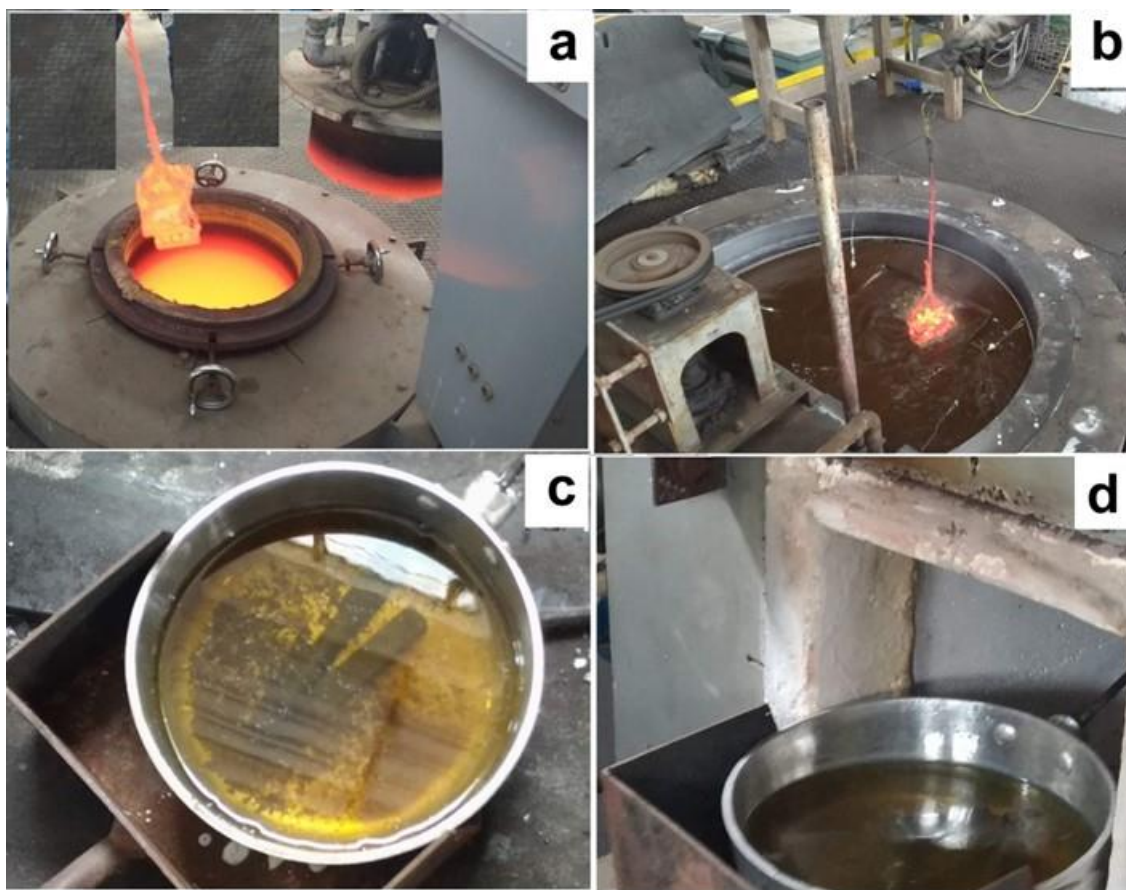
Figura 5.6: : Sequência das etapas de T&P convencional. (a) Retirada do forno de austenitização (880°C). (b) Transferência para um forno a banho de sais para a têmpera (170°C). (c e d) Corpos de prova transferidos para um cadinho contendo sais fundidos na temperatura de partição.
