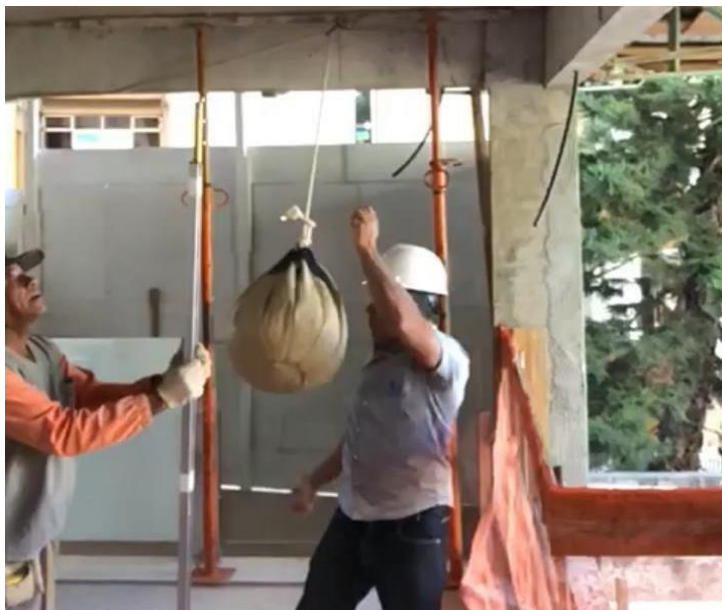
Figura 6 – Foto do ensaio de resistência a impactos evidenciando o movimento pendular, o saco de couro constituído de bolas de vidro submetido a uma distância de 5mm a 15 mm do guarda-corpo.
