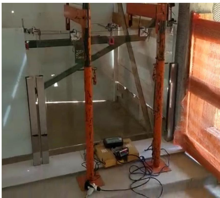
Figura 5 – Foto do ensaio de resistência a impactos, demonstrando o protótipo do guarda-corpo constituído por painel de vidro e gradil de alumínio.
