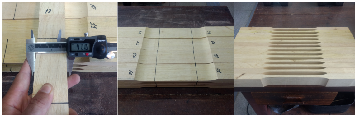
Figura 3.7: Corpo de prova de seção transversal retangular para ensaios da f_{t0} , representada por exemplares da espécie Caixeta.
