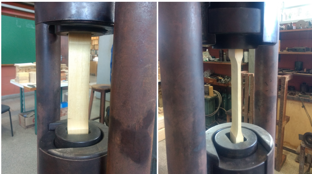
Figura 3.8: Vistas do corpo de prova para os ensaios da f_{t0} , representado por um exemplar da espécie Caixeta.
