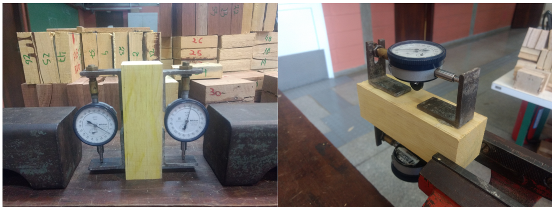
Figura 3.5: Padrão de fixação dos relógios comparadores no corpo de prova para uma amostra da espécie Caixeta.
