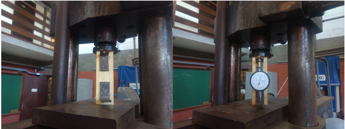
Figura 3.6: Posicionamento do corpo de prova e dos relógios comparadores para ensaio de compressão paralela às fibras para um exemplar da espécie Caixeta.
