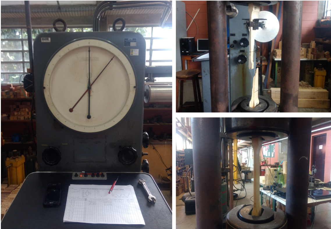
Figura 3.9: Máquina de ensaio universal adotada nos ensaios, com um corpo de prova na tração, durante e após o rompimento.
