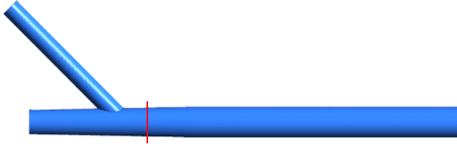
Figura 29 - Linha traçada para teste de independência de malhas. Fonte: Autoria própria, 2021.
