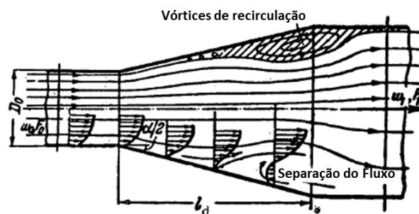
Figura 6 - Separação do fluxo de escoamento e formação de vórtices. Fonte: adaptado de IDELCHIK, 1966.
