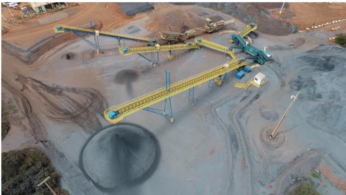
Figura 4.3 - Vista aérea da Usina de beneficiamento à seco das hematitas para a fase 1.
