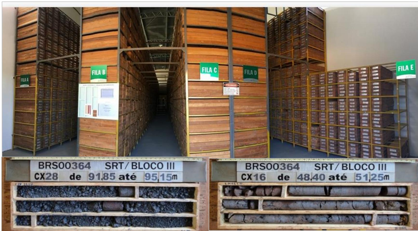
Figura 3.4 - Galpão de testemunhos e detalhe da acomodação dos testemunhos em caixas.
