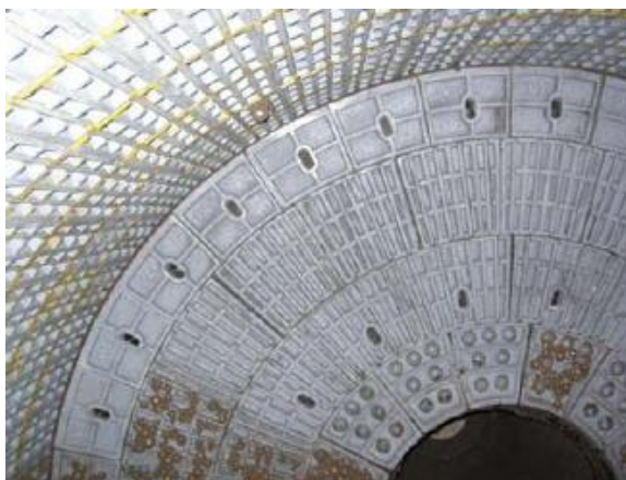
Figura 3.13: Visão interna do moinho com revestimento magnético (Ellsworth et al., 2009).
