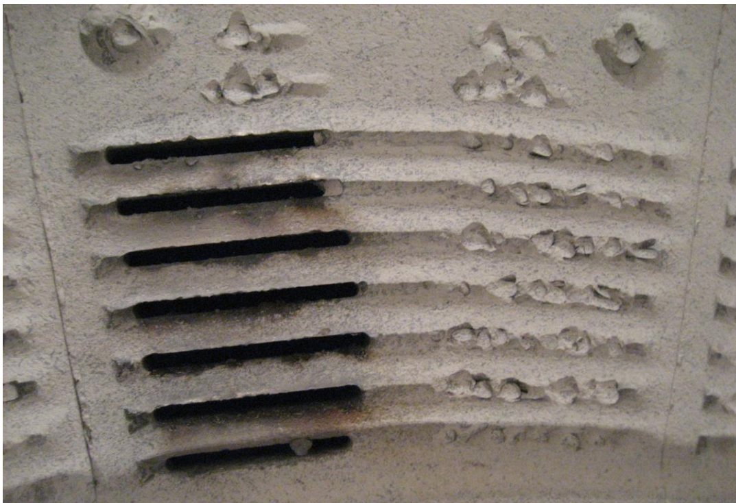
Figura 5.8: Efeito do procedimento de limpeza do diafragma de descarga do moinho.
