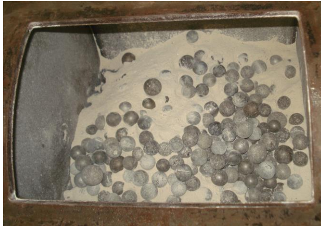
Figura 4.13: Alocação da massa de minério e da carga de bolas no moinho de torque para realização dos testes cinéticos ( U = 0,8 ).
