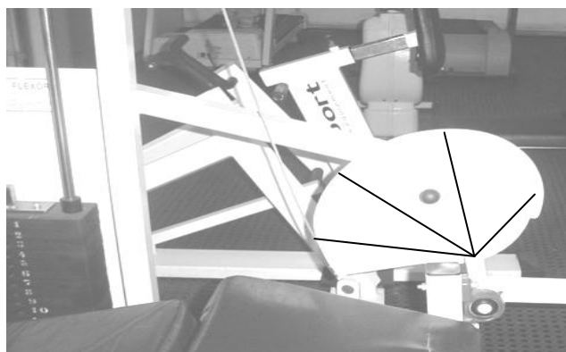
FIGURA 2.11. Princípio de funcionamento do camos, variação do braço de resistência.
