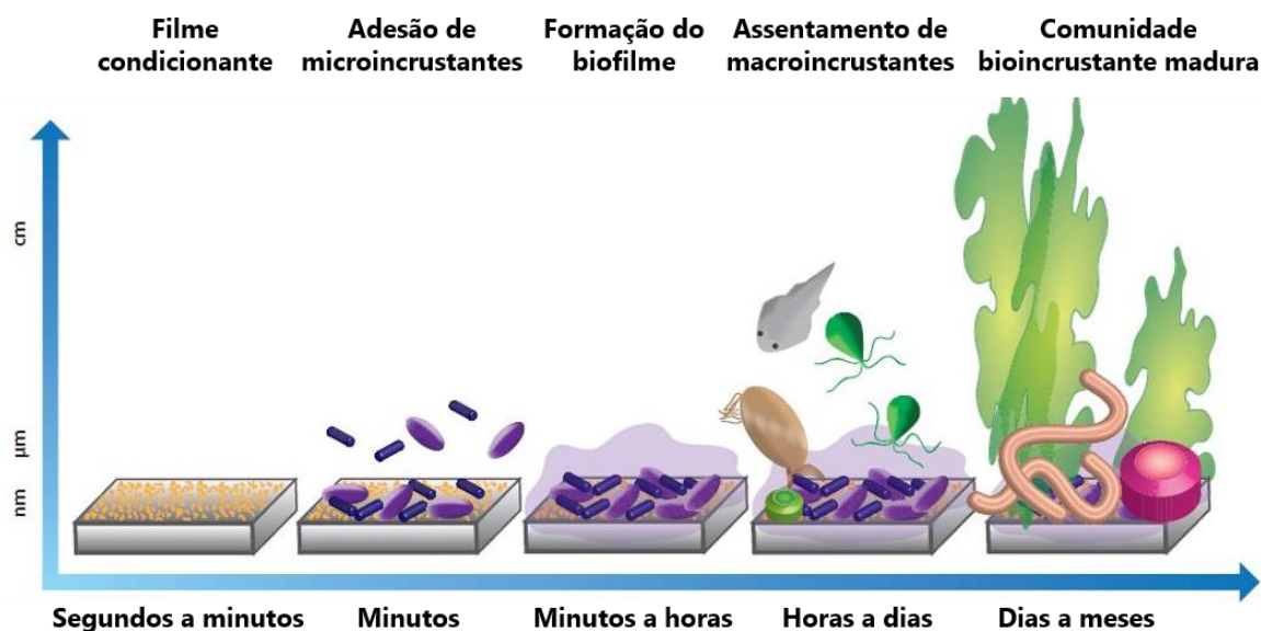
Figura 1. Sucessão do processo de bioincrustação. Moléculas orgânicas, de escala nanométrica, são carregadas pela água e revestem a superfície limpa, dentro de segundos, formando o filme condicionante. Decorridos alguns minutos, microrganismos, como bactérias e diatomáceas, começam a se aderir sobre o filme condicionante e formam o biofilme. Organismos macroincrustantes podem se assentar sobre o biofilme e, decorridos dias, ou até mesmo, meses, essa comunidade bioincrustante passa a ocupar um maior volume e torna-se madura, repleta de organismos micro e macroincrustantes que interagem entre si. Figura adaptada de Kirschner & Brennan, 2012.
