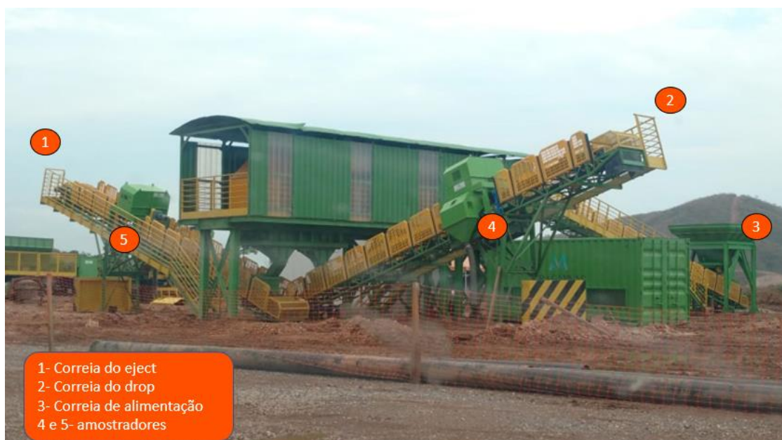
Figura 10: Fluxos de massa e amostragem do ore sorting de Vazante.
