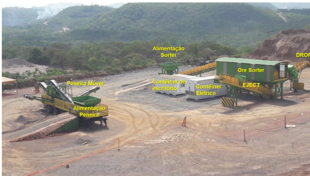
Figura 13: Equipamentos para teste industrial do sistema ore sorting
