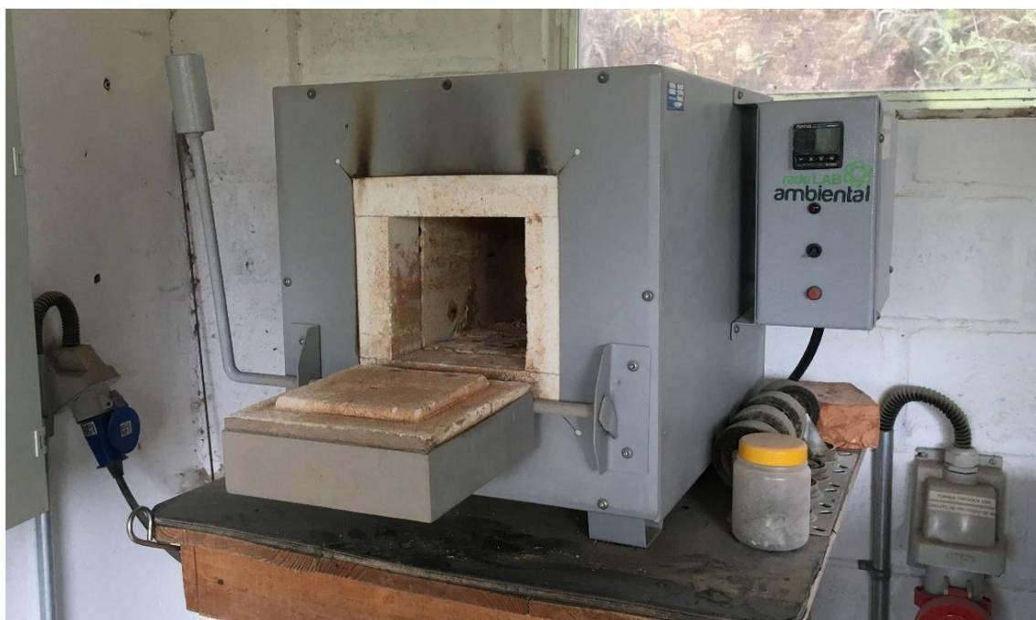
**Figura 4.50** Imagem da mufla utilizada nas reações de aumento de escala feitas no laboratório da Pedras Congonhas Ltda.
