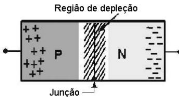
Figura 7 - Semicondutor com junção p-n. Fonte: (MELO, 2014).
