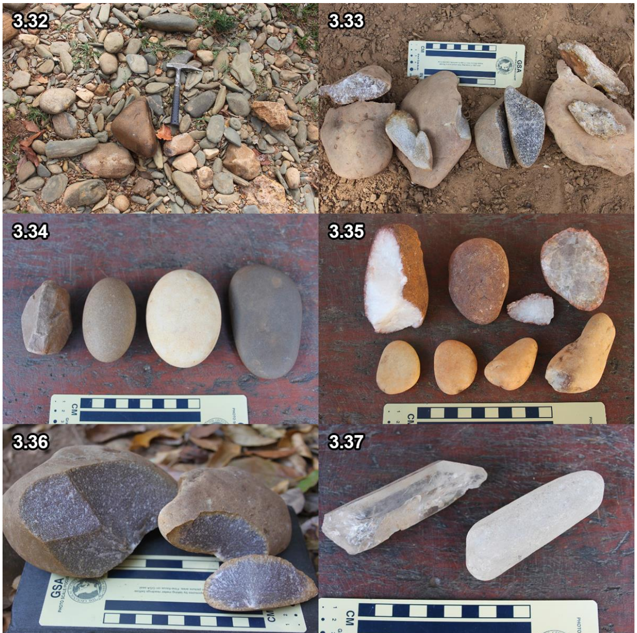
Foto 3.32-Padrão de fotografia para registro de uma quadra fluvial (área próxima a 1 m 2 ), onde são feitas a contagem e a classificação dos seixos (riacho Fundo). Foto 3.33-Seixos de quartzito partidos ao martelo para análise interna. Foto 3.34-Seixos de quartzito nas formas (esquerda para a direita) poliédrica, ovoide, discoide e elipsoide. Foto 3.35-Seixos de quartzito com superfícies rugosa e oxidada (em cima) e lisa (embaixo). Foto 3.36-Seixos de quartzito cinza fino maciço homogêneo partidos ao martelo. Foto 3.37-Monocristal de quartzito hialino (à esquerda) e seixo fluvial prismático de monocristal de quartzito (à direita).
