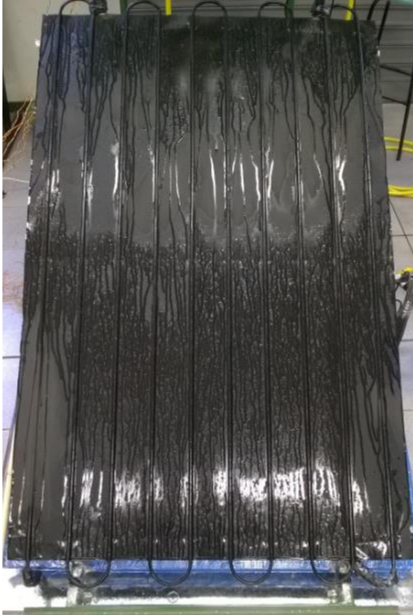
FIG. 3.12: Evaporador solar saturado de condensado
