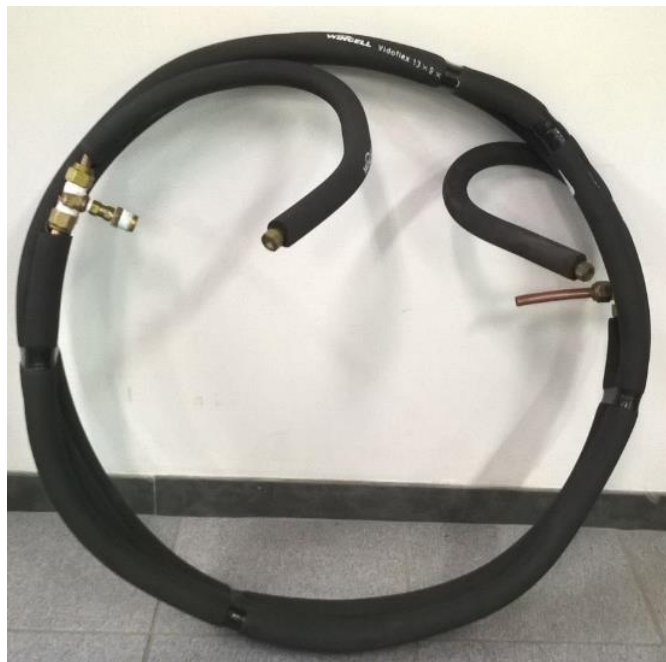
FIG. 3.20: Condensador coaxial fabricado
