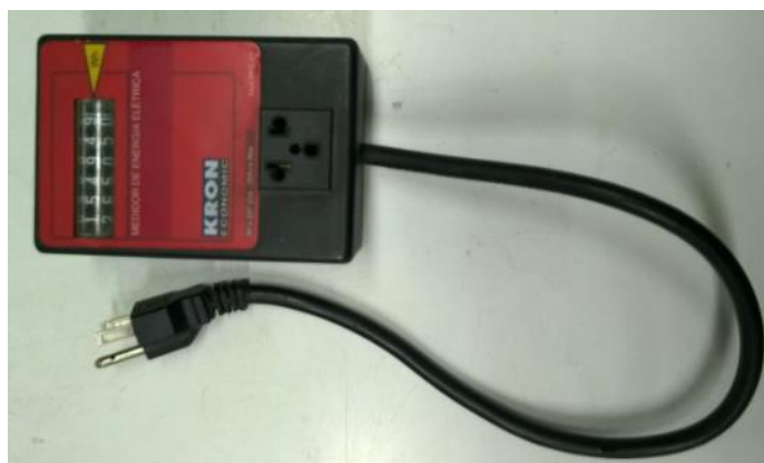
FIG. 3.25: Medidor de energia elétrica de consumo do compressor utilizado
