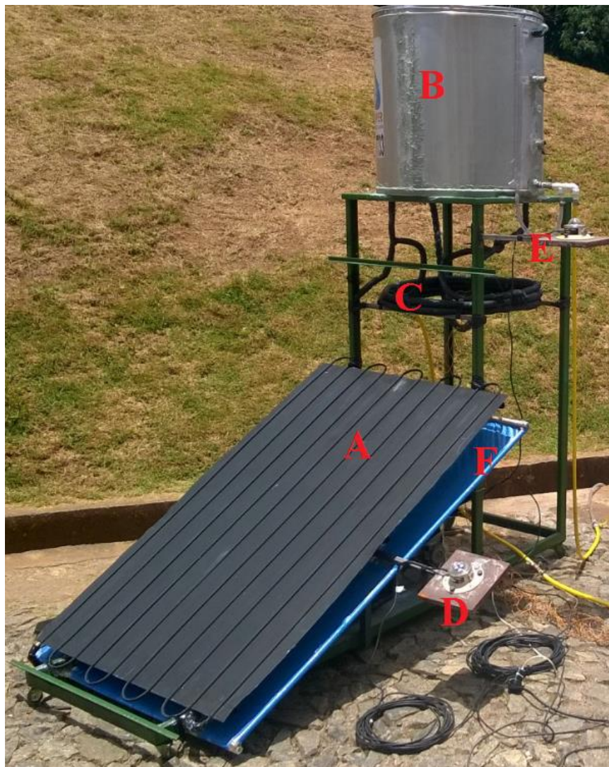
FIG. 3.3: Vista geral da BDC. Evaporador solar (A), tanque (B), condensador coaxial (C), piranômetro inclinado (D), piranômetro horizontal (E) e dispositivo de coleta de condensado (F)
