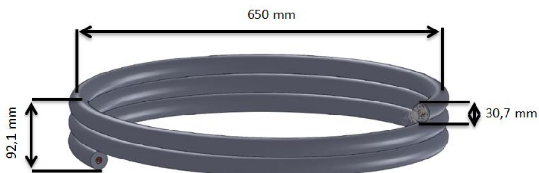
FIG. 3.22: Dimensões do condensador coaxial
