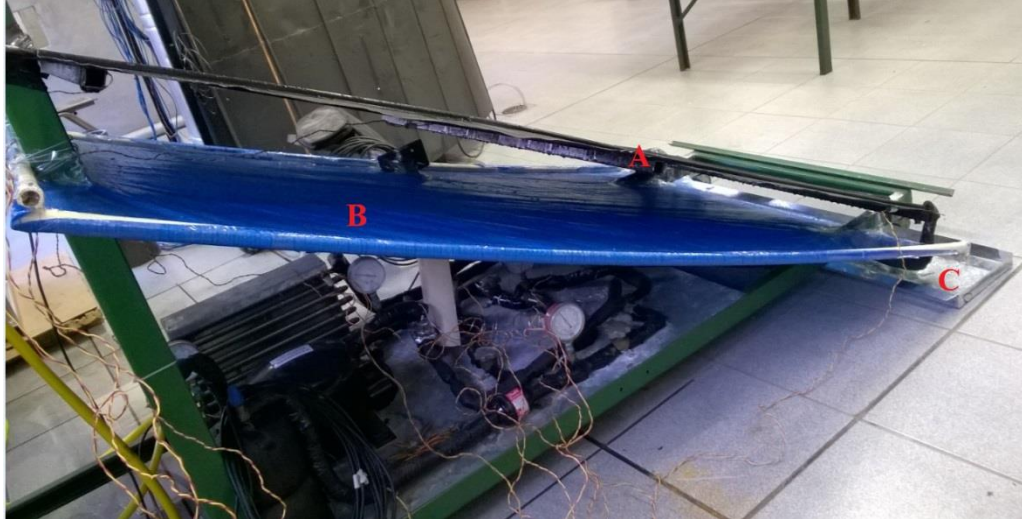
FIG. 3.11: Dispositivo para coleta de condensado. (A) Placa (evaporador solar), (B) lona para coleta de condensado da porção posterior da placa e (C) calha para armazenamento do condensado
