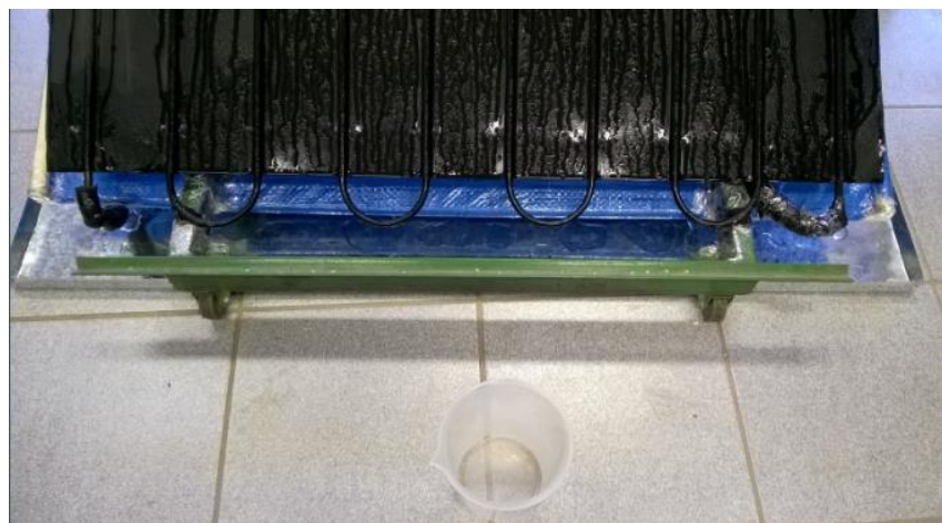
FIG. 3.13: Armazenamento do condensado pela calha e coleta pelo recipiente
