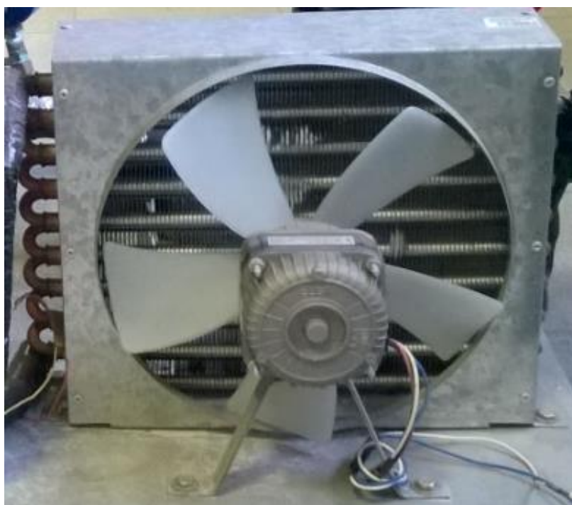
FIG. 3.6: Evaporador convencional e eletro ventilador
