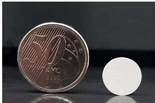
**Figura 3.2 - Fotografia do suporte obtido por prensagem uniaxial.**
