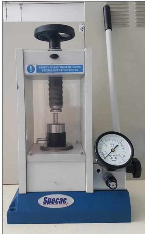
**Figura 3.1 - Prensa manual hidráulica Specac.**
