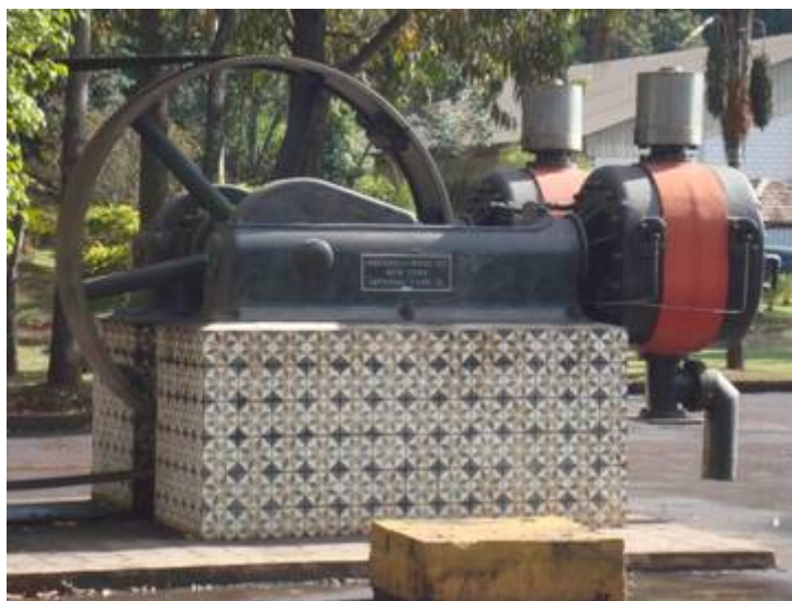
FIG. 15 - Gerador a vapor norte-americano marca Ingersoll-Rand utilizado na Usina Queiróz Júnior no início do século XX. A demanda por energia era localizada na planta siderúrgica, portanto, fixa e previsível, diferente das demandas crescentes e imprevisíveis das grandes empresas de mineração. (Acervo do Autor).
