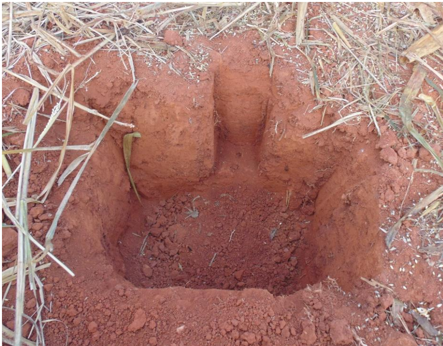
Fig. 4. Minitrincheira para coleta nas amostras de solo no local de estudo
