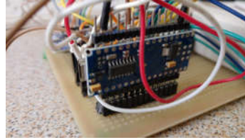
Figura 3.24. Gerador de setpoint de movimento cartesiano
