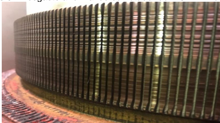
Figura 3.5 - Desgaste anormal do comutador do MCVR - filetamento.
