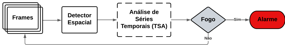
Figura 2 – Sistema híbrido de detecção de fogo proposto baseado em duas etapas: detecção espacial e análise de séries temporais.
