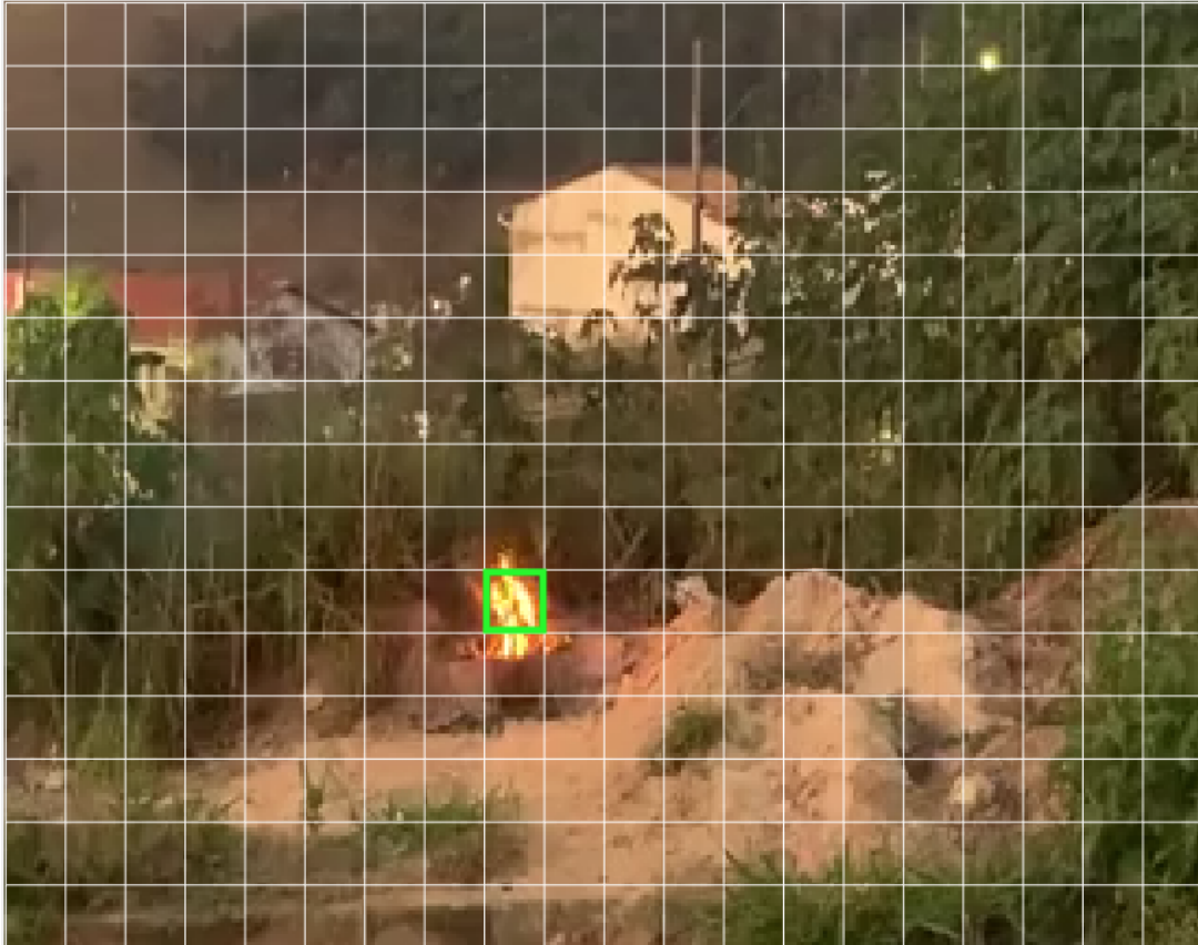
Figura 23 – Quadro de um vídeo dividido em blocos de tamanho N = 16 \times 16 pixels . Em destaque (cor verde) um bloco pertencente à região de fogo. A dimensão da imagem é de 320 \times 240 pixels e possui ao todo 300 blocos, cada um com 256 pixels .
