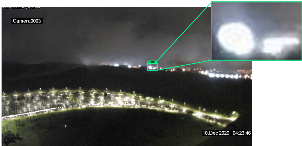
Figura 22 – Região de interesse (falso positivo) detectada pelo algoritmo YOLO em um quadro de um vídeo com dimensão de 1280 \times 720 pixels . Ampliação da ROI com dimensão igual a 45 \times 61 pixels .
