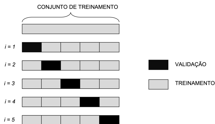
Figura 16 – Esquema do método de validação cruzada k-fold com k = 5 . O conjunto de dados é dividido em k partes iguais.
