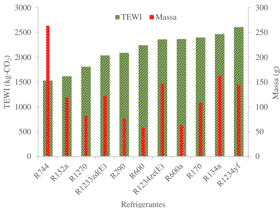
Figura 4.3: TEWI total e massa de refrigerante total relativo aos trocadores de calor.
