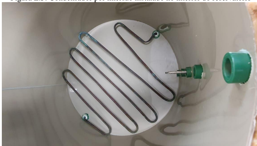
Figura L.5: Condensador por imersão instalado no interior do reservatório
