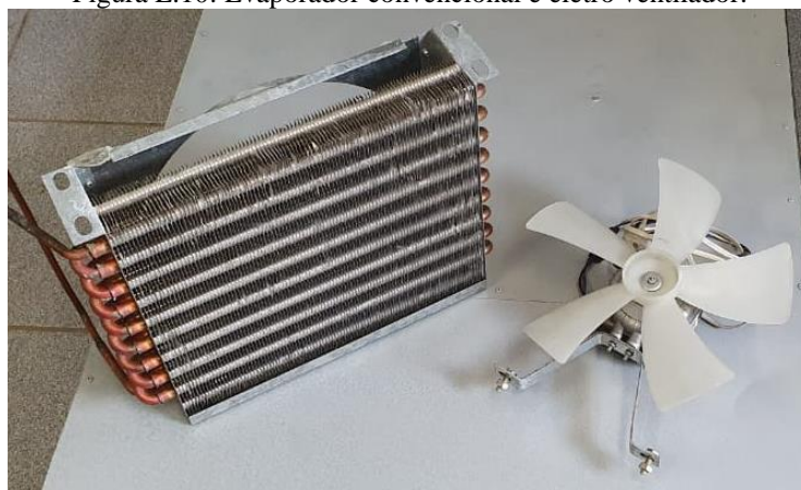
Figura L.10: Evaporador convencional e eletro ventilador.
