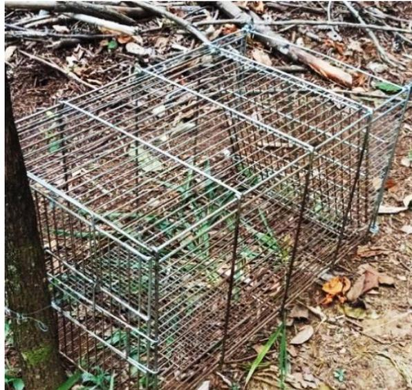
**Figura 11:** Armadilha do tipo Tomahawk ® com desarme de pedal de dimensões de 70 cm x 35 cm x 40 cm.
