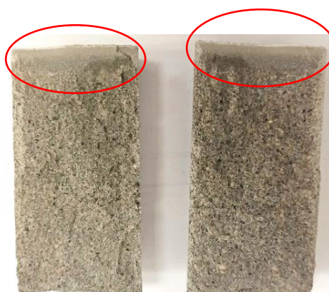
Figura 22 - Corpo de prova rompido à tração por compressão diametral, aos 7 dias, da argamassa de traço referente ao Ajuste 1.
