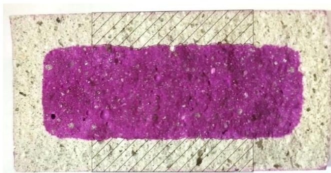
Figura 17 – Corpo de prova do grupo ArRef, carbonatado, rompido à tração por compressão diametral aos 43 dias de idade (27 dias em câmara de carbonatação), após aspersão de solução de fenolftaleína. Área central demarcada em AutoCAD.
