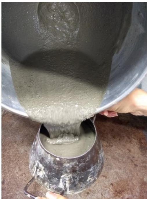
Figura 18 - Graute de mercado sendo vertido em tronco de cone.
