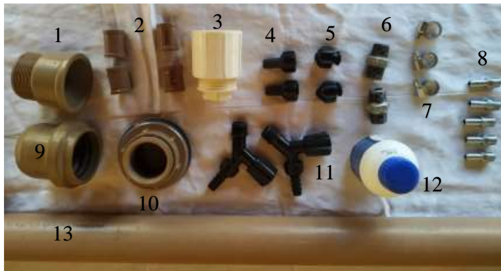
Figura 26 – Alguns materiais utilizados na montagem do biodigestor de batelada adaptado
