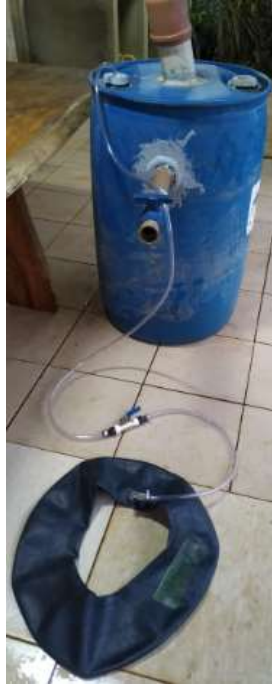
Figura 2 – Biodigestor construído no primeiro dia de operação
