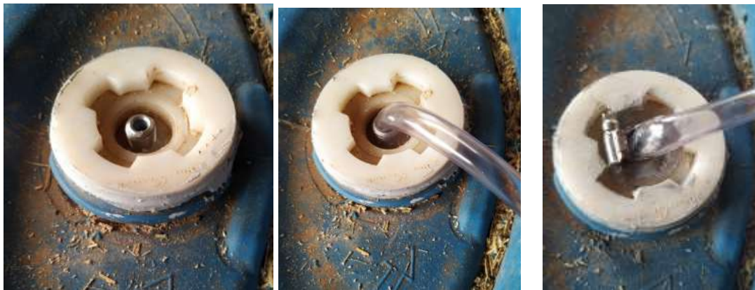
Figura 35, 36 e 37 -- Detalhe com uma das tampas menores do tambor plástico, perfurada para encaixe do nípel, mangueira de gás e abraçadeira.
