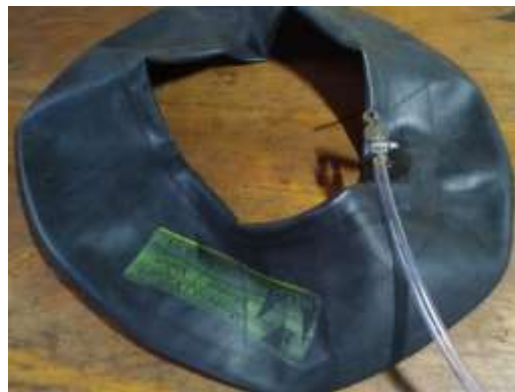
Figura 41 – Ligação entre bico de enchimento e a câmara emborrachada que receberá o biogás produzido.
