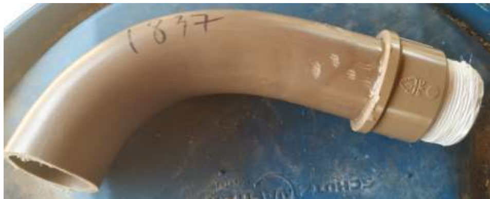
Figura 33 –Curva pvc 50mm, encaixada no adaptador curto soldável com rosca. A extremidade rosqueável do adaptador, está envolvida com fita veda rosca.
