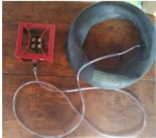
Figura 16 –Câmara de ar conectada ao fogareiro
