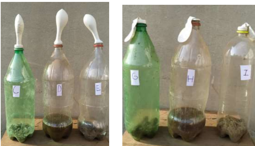
Figuras 10 e 11 – Experimento simulando um mini biodigestor em detalhe parcial. Dia 11 (ao sol)
