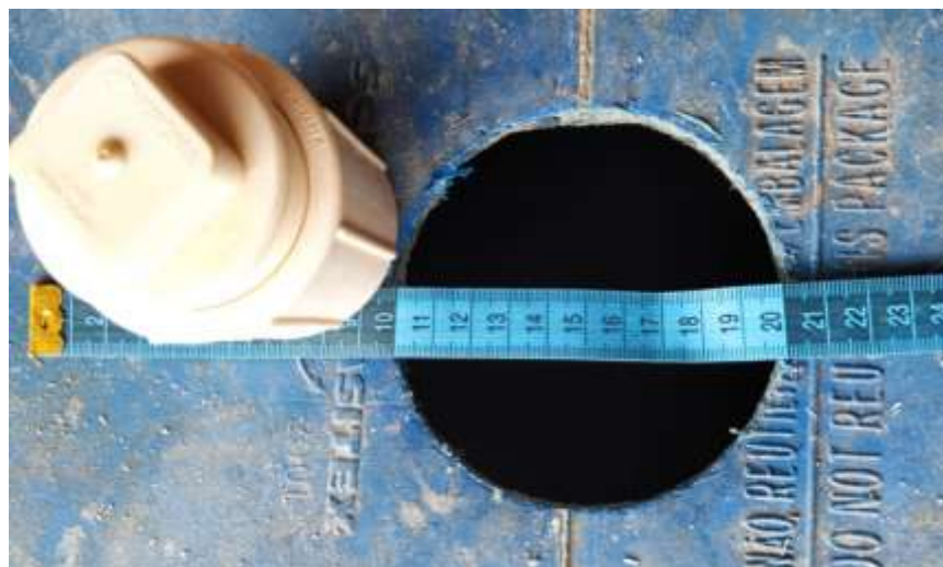
Figura 30 –Detalhe do tambor plástico (200 litros) com orifício central superior, realizado com a serra copo (100mm = 10cm).
