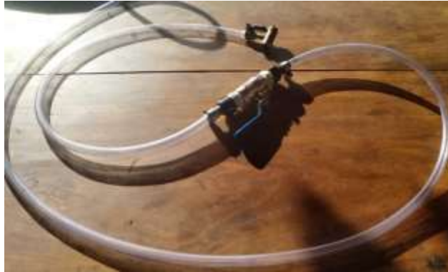
Figura 40 –Mangueira de condução do biogás com registro e bico.
