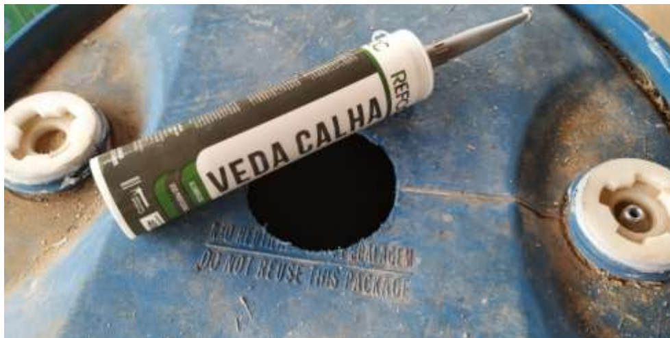
Figura 38 –Veda calha utilizado para vedação dos encaixes das peças e tubos nas aberturas do tambor plástico.
