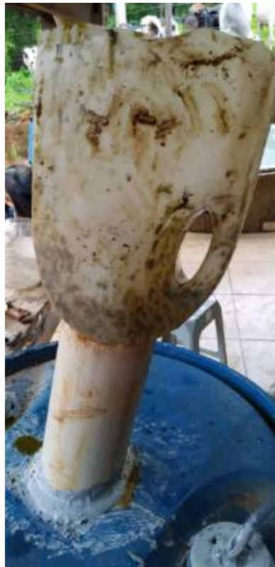
Figura 45 –Colocação do material dentro do biodigestor.
