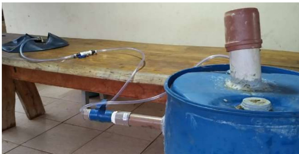
Figura 43 –Visualização da colocação do tubo pvc, no orifício superior central e registro lateral.
