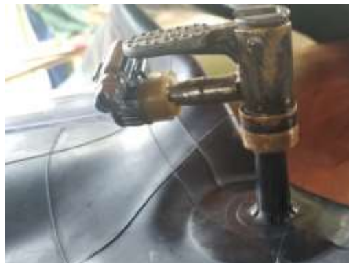
Figura 42 –Detalhe da ligação entre bico de enchimento e a câmara emborrachada que receberá o biogás produzido.
