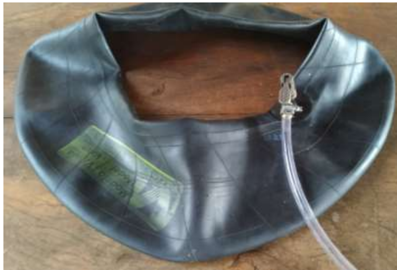
Figura 12 – Câmara de ar no 12º dia de operação do biodigestor
