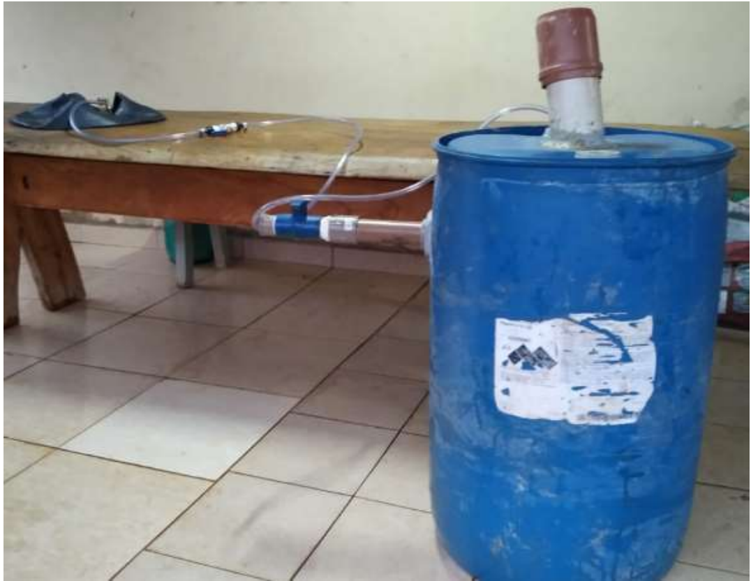
Figura 46 – Biodigestor de batelada adaptado após a conclusão da montagem e carregamento de biomassa.
