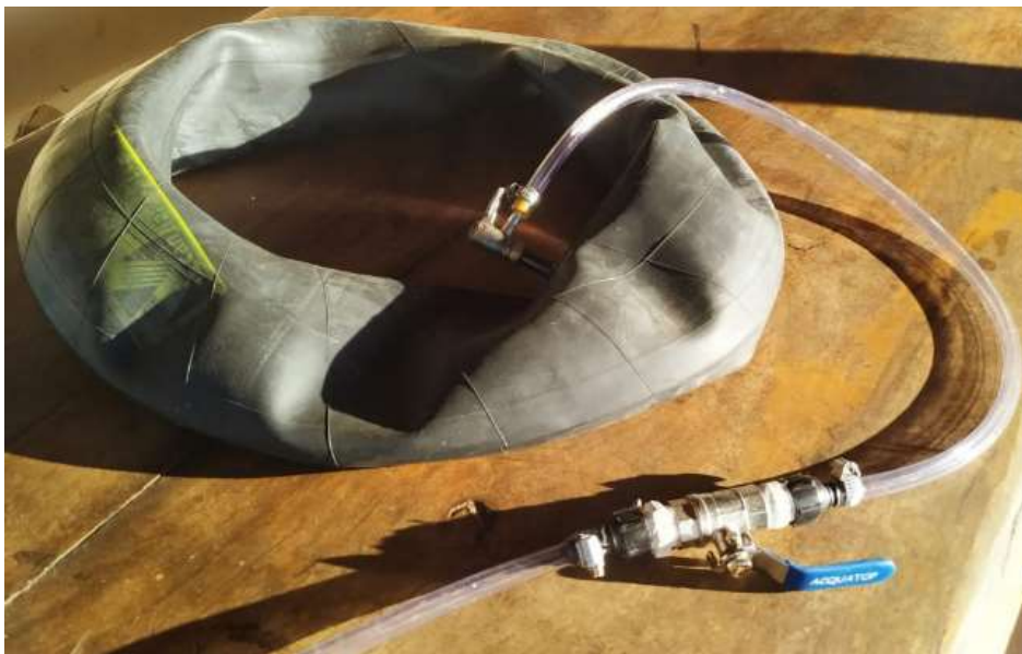
Figura 13 –Câmara de ar no 15º dia de operação do biodigestor
