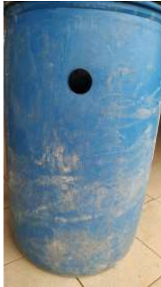
Figura 31 – Detalhe do tambor plástico (200 litros) com furo aberto a 65 cm de altura da base, por cano 50mm aquecido
