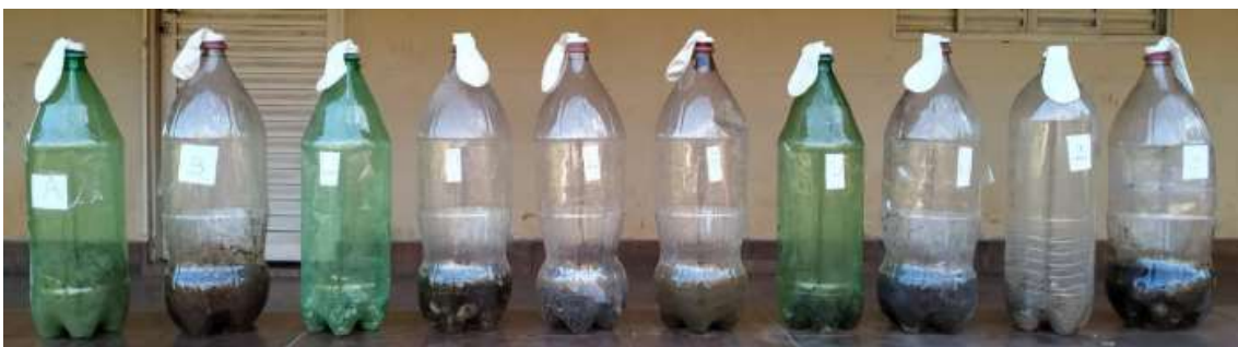
Figura 1 - Experimento simulando um mini biodigestor simples. Dia 1 (montagem)
